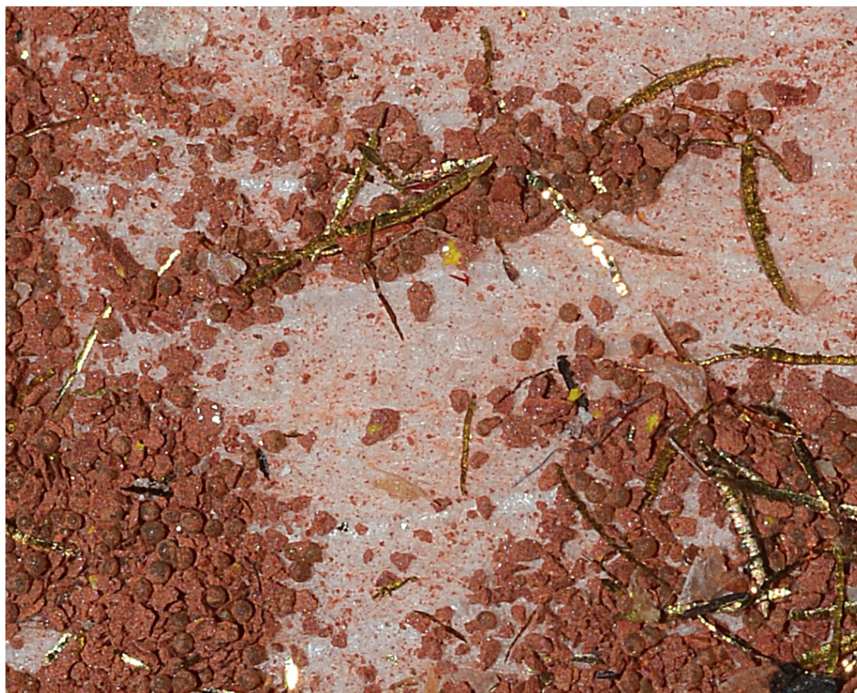
Figur 3.1 Støv fra sikting av tennhetter (Sintox). Støvet er fotografert på et tørkepapir som lå under sikten for å samle opp støv (Foto: FFI)
