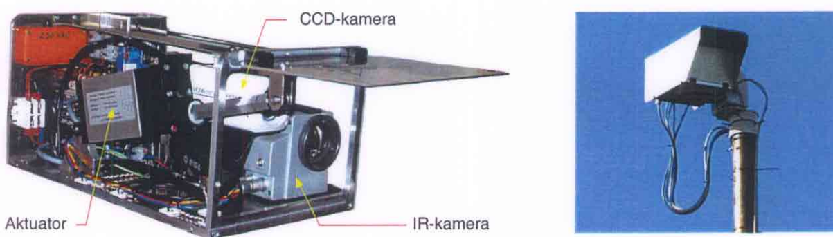
Figur 2.7 Værhuset uten deksel med åpen luke (til venstre) og i masten (til høyre) Til venstre sees en del av elektronikken, kameraene og aktuatoren som åpner luken.
