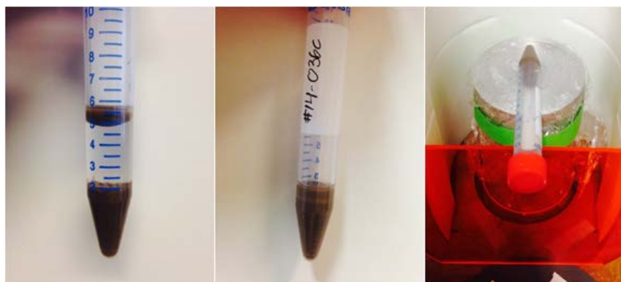
Figur 3.8 Til venstre: Prøvetuben med jord og DCM etter blanding og sentrifugering. I midten: Den faste fasen etter uttak av væskefasen. Til høyre: Posisjonen til den faste fasen (jorda) under gammaspktrometrisk analyse.
