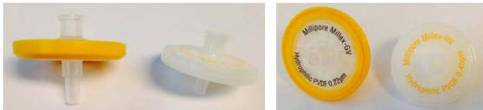
Figur 3.2 Filtrene benyttet til filtrering av prøvene. Til venstre i hvert bilde vises et 0,22 \mu\text{m} -sterilfilter (ref: SLGV033NB). Til høyre vises et 0,45 \mu\text{m} -filter(ref: SLHV025NB).
