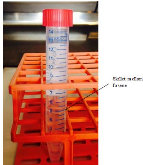
Figur 3.4 Illustrasjon av ekstraksjonen mellom R(aq) (vandig fase) og DCM (organisk fase).
