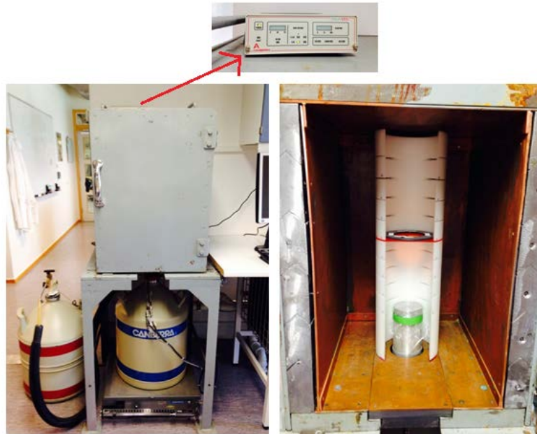
Figur 3.3 Det gammaspektrometriske utstyret ved FFI. Til venstre vises hele oppsettet med tilhørende mangekanalanalysator, til høyre innsiden av blyskapet med stativ og detektor.
