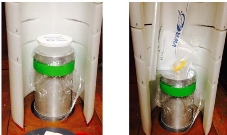
Figur 3.6 Posisjoner under den gammaspektrometriske analysen. Til venstre: filtratet. Til høyre: filteret.
