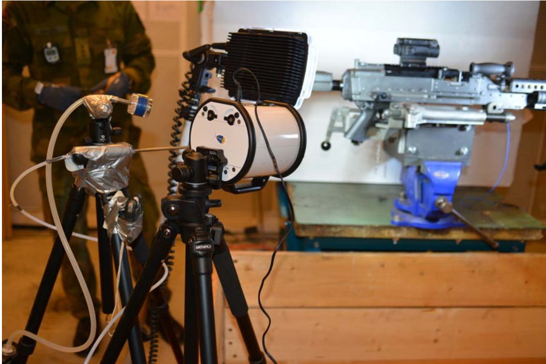
Figur 2.2 Bildet viser oppsett av våpen og analyseinstrumentene.
