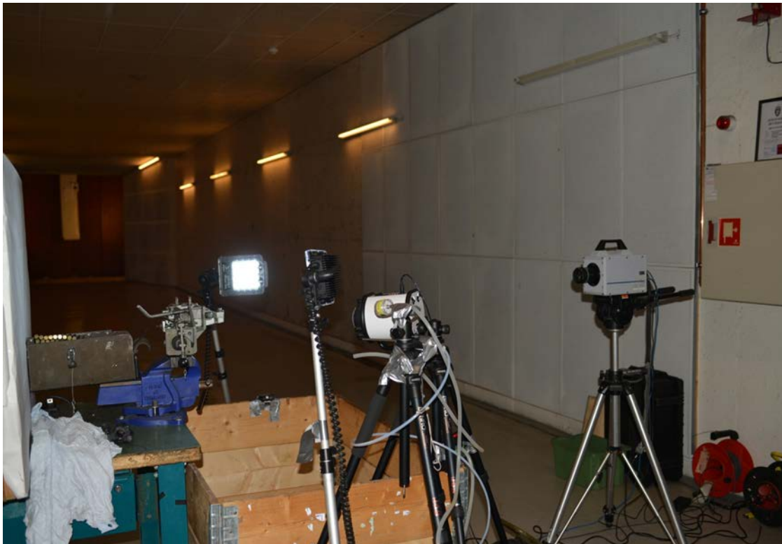
Figur 2.3 Bildet viser oppsett av våpen og analyseinstrumentene.
