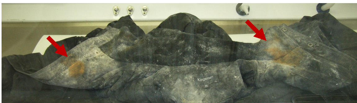
Figur 4.1 Innsiden av jakkekragen, der påvisningspulver for kjemiske stridsmidler var blitt påført. De to pilene viser hvor rødbrune fargeomslag kan observeres.
