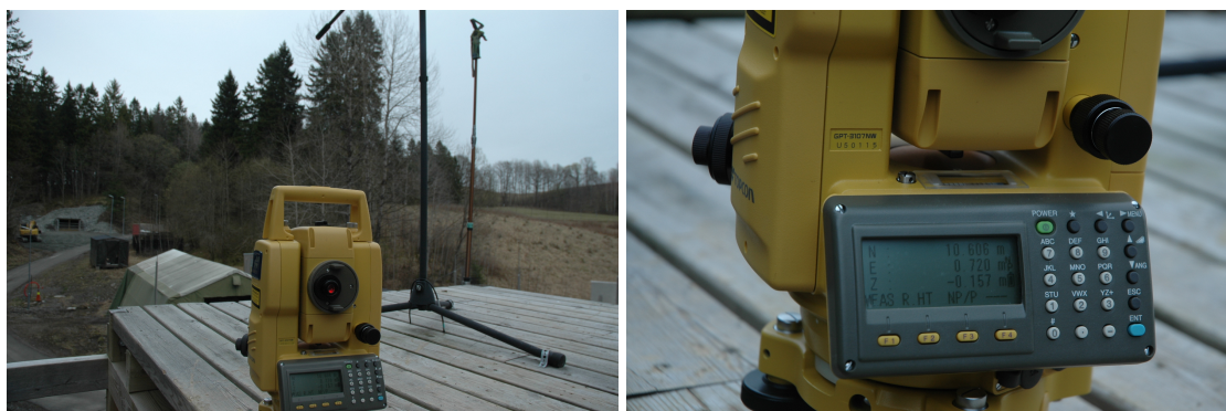
Figur 2.1 Totalstasjon for oppmåling av sensorposisjoner: Topcom GPT 3107NW. Til høyre vises koordinater i aksekorset som bestemmes ved oppstart av instrumentet.
