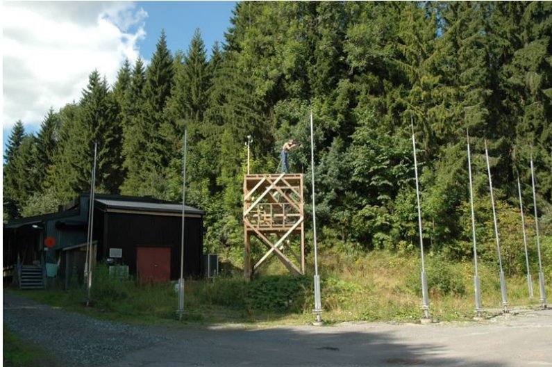
Figur 1.1 Måleoppsettet med 8 mikrofoner 10 m fra munningen.
