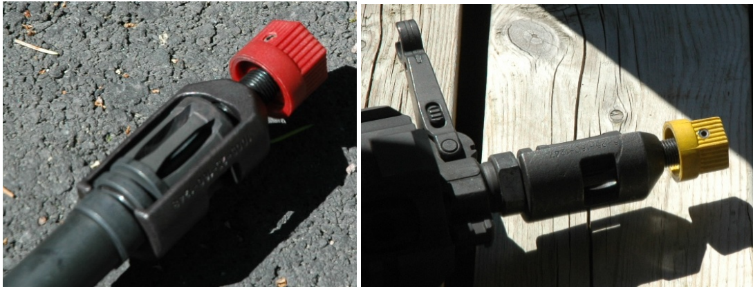
Figur 5.3 Rekylforsterkere. Til venstre HK 416N. Til høyre HK 416K.
