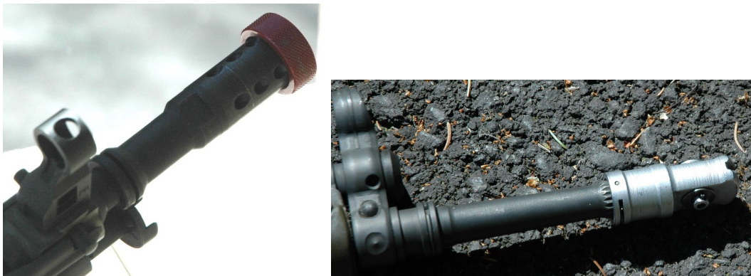
Figur 5.4 Rekylforsterkere. Til venstre Minimi 5.56 mm Para. Til høyre AG3.
