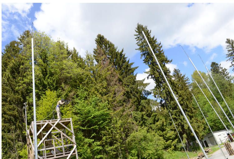
Figur 3.1 FFIs måleanlegg for støy fra håndvåpen.
