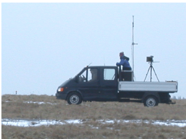
Figur 2.4 Sender er montert på bil for enkelt å kunne forflytte seg langs flystripa, mens mottakeren til høyre var fast plassert i enden av rullebanen
