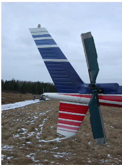
Figur 2.3 Detaljert bilde av halerotoren som viser strukturer som skjermer halerotoren deler av tiden
