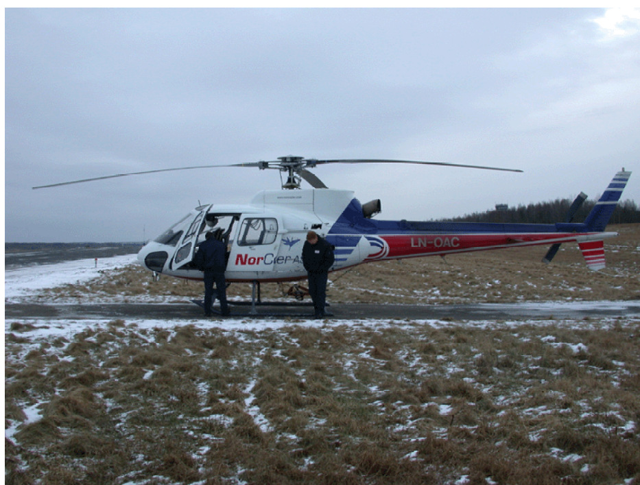
Figur 2.2 Bildet viser helikopteret som ble brukt i målingene, av typen Eurocopter AS350B2
