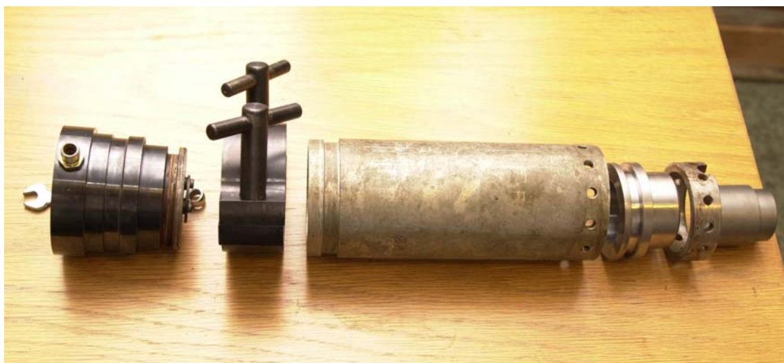
Figur 3.6 Motoren i de enkelte bestanddeler. Fra venstre: Frontstykke, låsering, motorrør, endestykke, bruddboltring og dyse.
