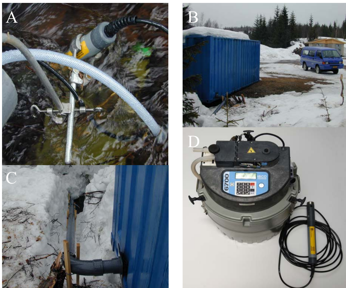
Figur 3.5 Bilde A: multisonden plassert i bekken. Bilde B: containeren som ble benyttet for plassering av vannprøvetakeren. Bilde C: røret for beskyttelse av slanger og ledninger som gikk ned til bekken. Bilde D: vannprøvetakeren og multisonden
