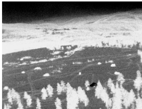
Figur 5.9 Termisk bilde som illustrerer røpende effekt ved bruk av lav-emissivt materiale. Kamuflasjematerialet speiler en kald himmel, og flatens tilsynelatende temperatur blir mye lavere enn temperaturen i bakgrunnen.
