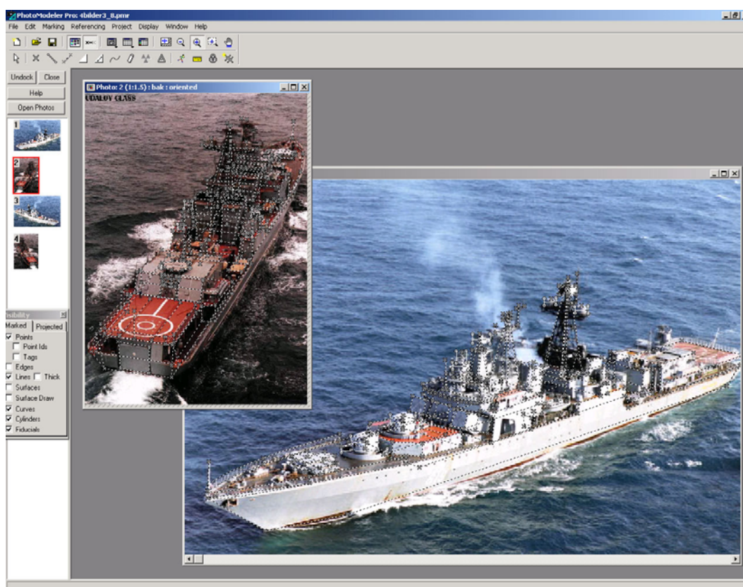
Figur 3.3 Skjerm bilde fra PhotoModeler som viser de bildene som er brukt for å lage wireframe-modell av en Udaloy-klasse jager
