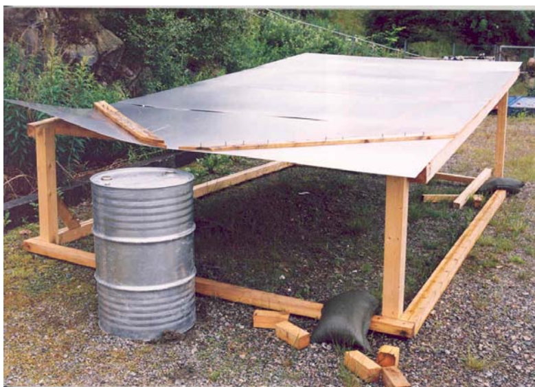
Figur 2.8 Prøvetaking av nedbør ved HOS
