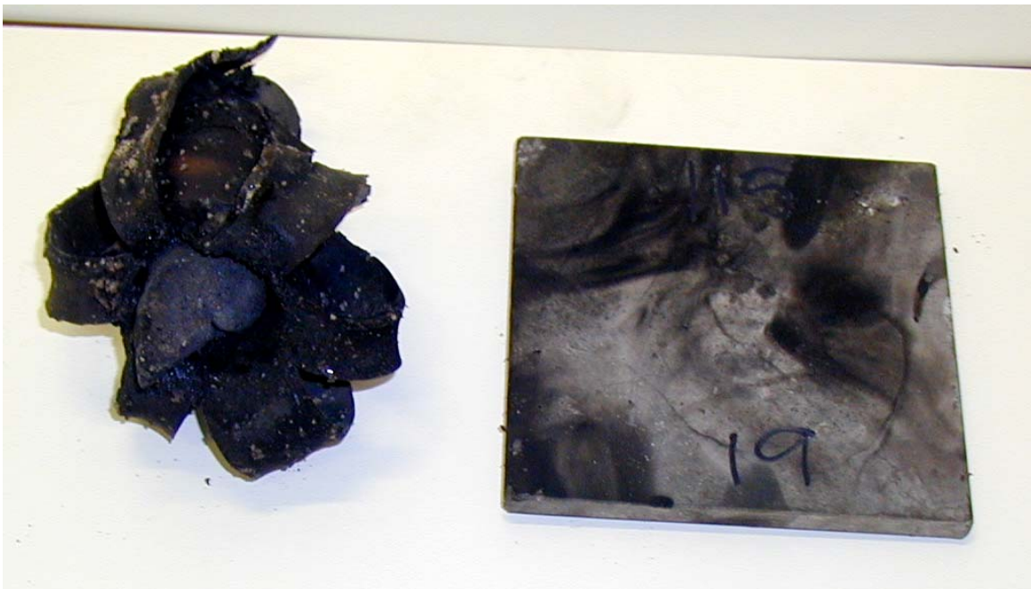
Figur 3.20 Skudd 9, rør 19 med PBXN-109-IIH2, 115 kort, ikke omsatt.
