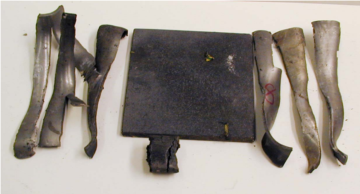
Figur 3.25 Skudd 3 rør 8 med PBXN-109-IIG2, 100 kort, ikke omsatt.
