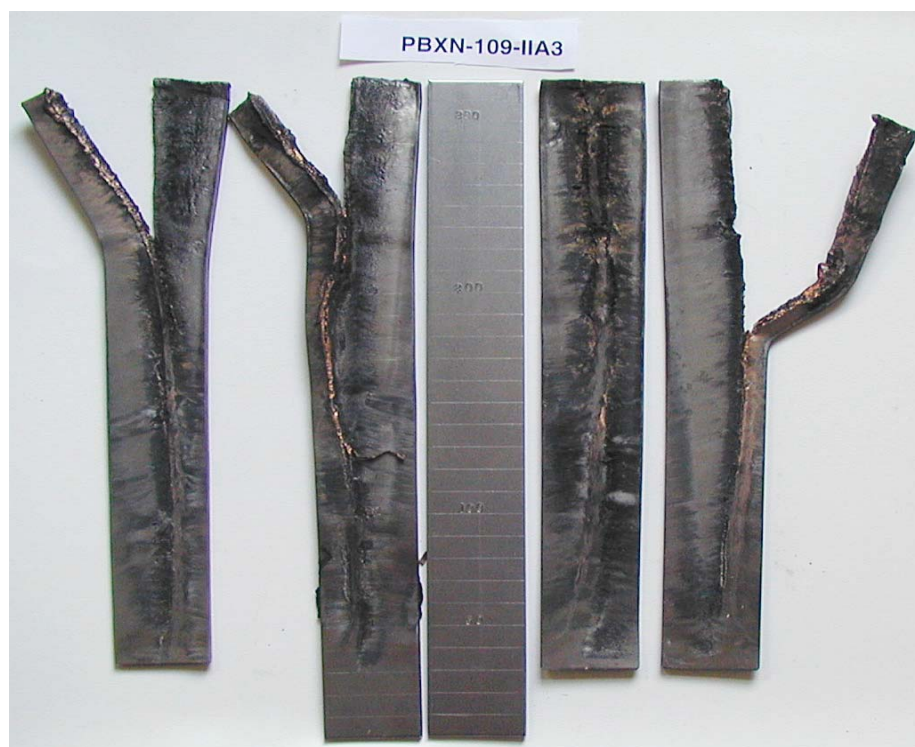
Figur 3.7 Bilde av vitneplatene for testseriene som inneholdt PBXN-109-IIA3.
