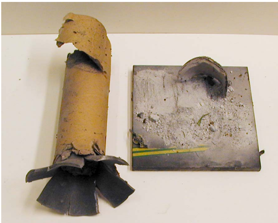
Figur 3.23 Skudd 1, rør 6 med PBXN-109-IIG2, 120 kort, ikke omsatt.
