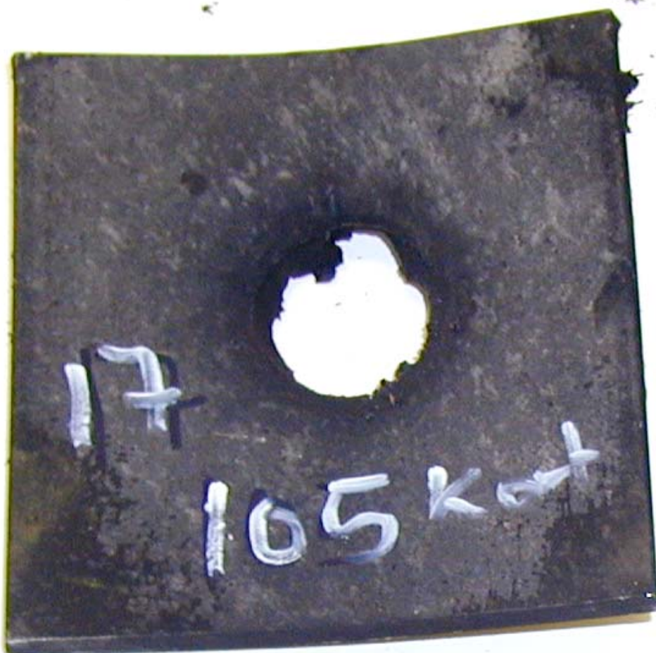
Figur 3.17 Skudd 6, rør 16 med PBXN-109-IIH2, 105 kort ikke omsatt.
