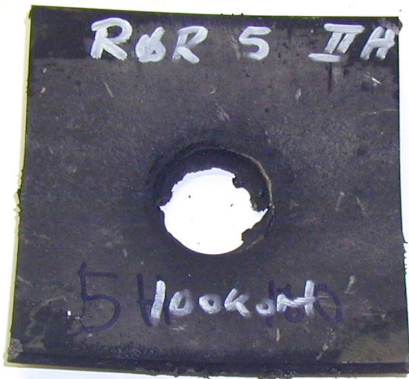
Figur 3.16 Skudd 5, rør 5 med PBXN-109-IIH1, 100 kort, omsatt.
