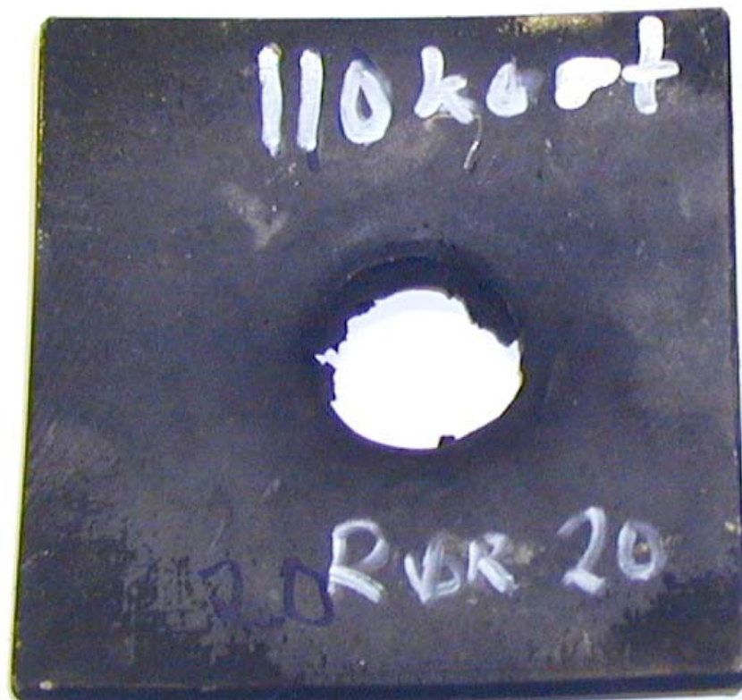
Figur 3.21 Skudd 10, rør 20 med PBXN-109-IIH2, 110 kort, omsatt.
