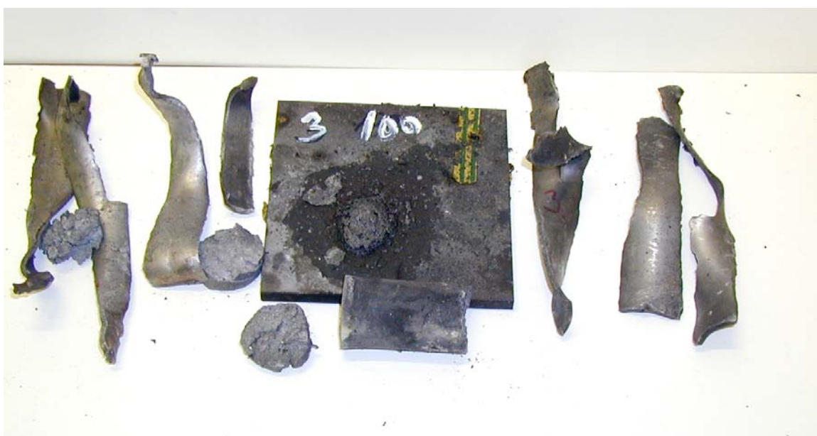
Figur 3.14 Skudd 3, rør 3 PBXN-109-IIH1, 100 kort, ikke omsatt.
