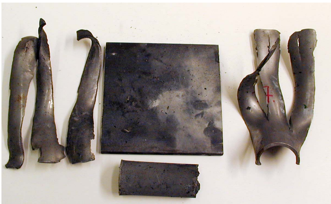
Figur 3.24 Skudd 2, rør 7 med PBXN-109-IIG2, 100 kort, ikke omsatt.
