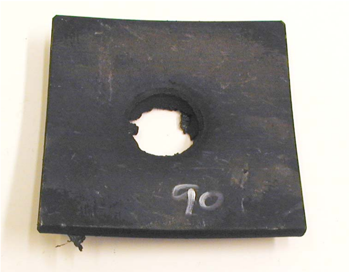
Figur 3.26 Skudd 3 rør 10 med PBXN-109-IIG2, 95 kort, omsatt.
