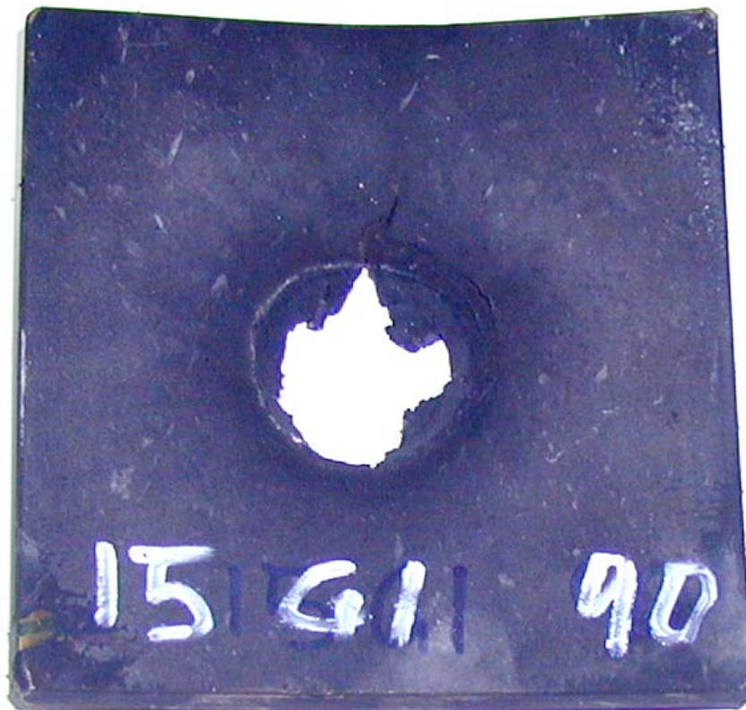
Figur 3.31 Skudd 9, rør 15 med PBXN-109-IIG1, 90 kort omsatt.
