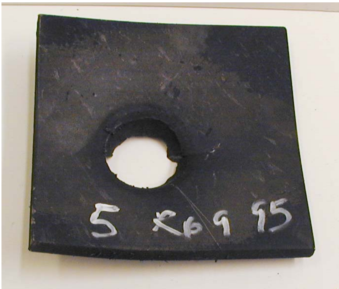
Figur 3.27 Skudd 5, rør 9 med PBXN-109-IIG1, 95 kort, omsatt.
