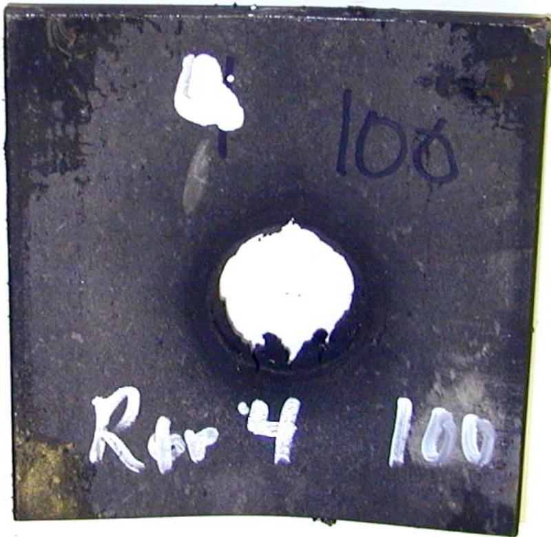
Figur 3.15 Skudd 4, rør 4 med PBXN-109-IIH1, 100 kort, omsatt.
