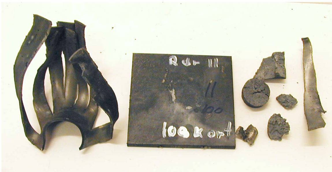
Figur 3.28 Skudd 6, rør 11 med PBXN-109-IIG1, 100 kort, ikke omsatt.
