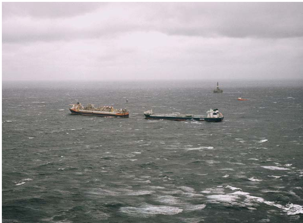
Figur 6.12 Produksjonsskipet på Nornefeltet (til venstre) sammen med et skyttelskip som transporterer olje til et raffineri, samt en borerigg og et nød fartøy.
