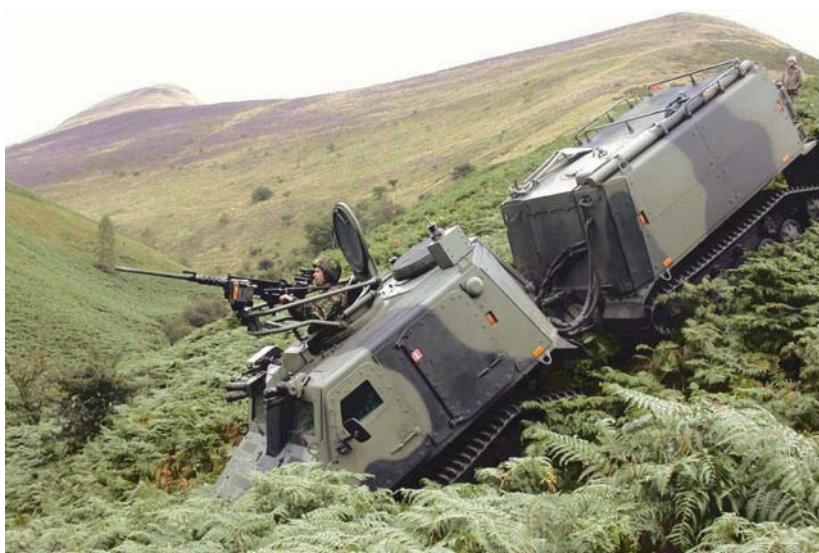
Figur 3.4 Viking/BvS10 kan kjøre opptil 45 grader
