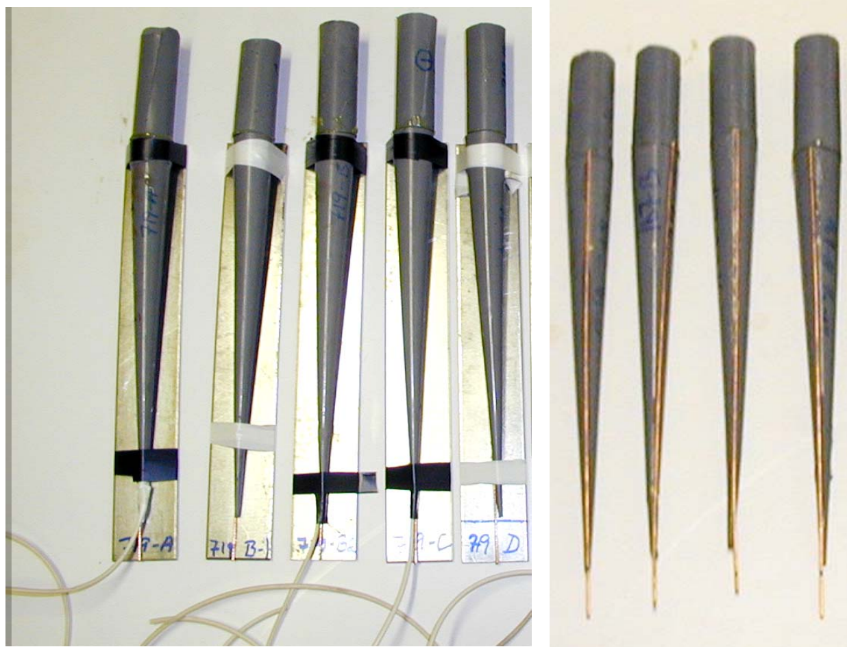
Figur 3.5 Bilder av testlegemer før testing. Til høyre hvordan koppertråd er plassert og til venstre total oppsett.
