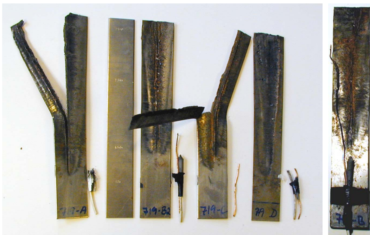
Figur 3.5 Bilder av testlegemer før testing. Til høyre hvordan koppertråd er plassert og til venstre total oppsett.
