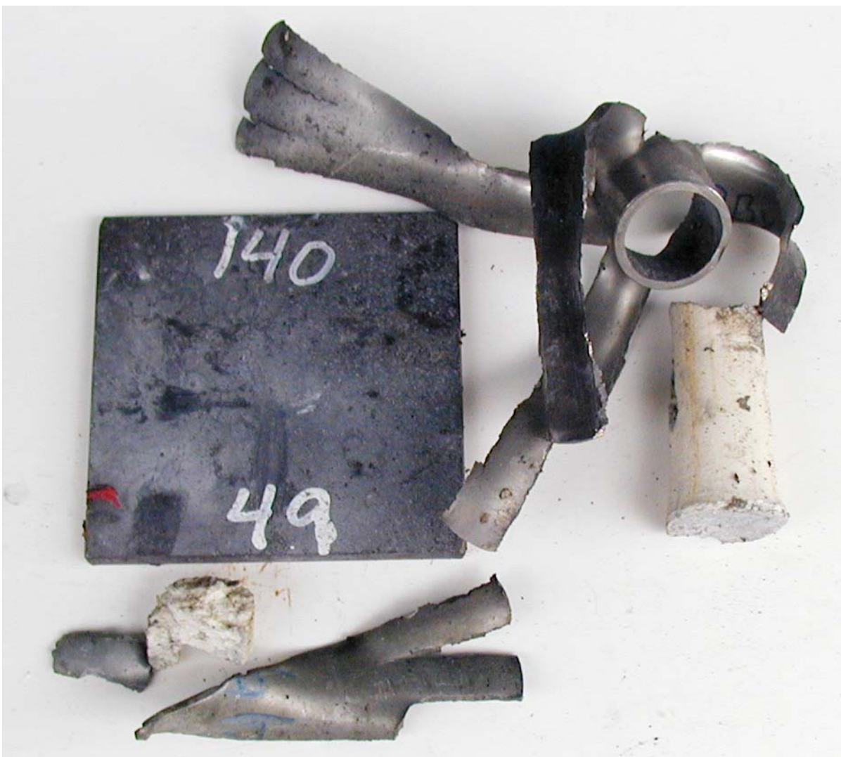
Figur 3.9 Skudd 6, rør 49 fylt med PBXN-110C, 140 kort, ikke omsatt.
