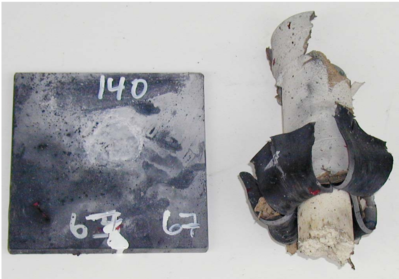
Figur 3.6 Skudd 3, rør 67 fylt med PBXN-110, 140 kort, ikke omsatt.
