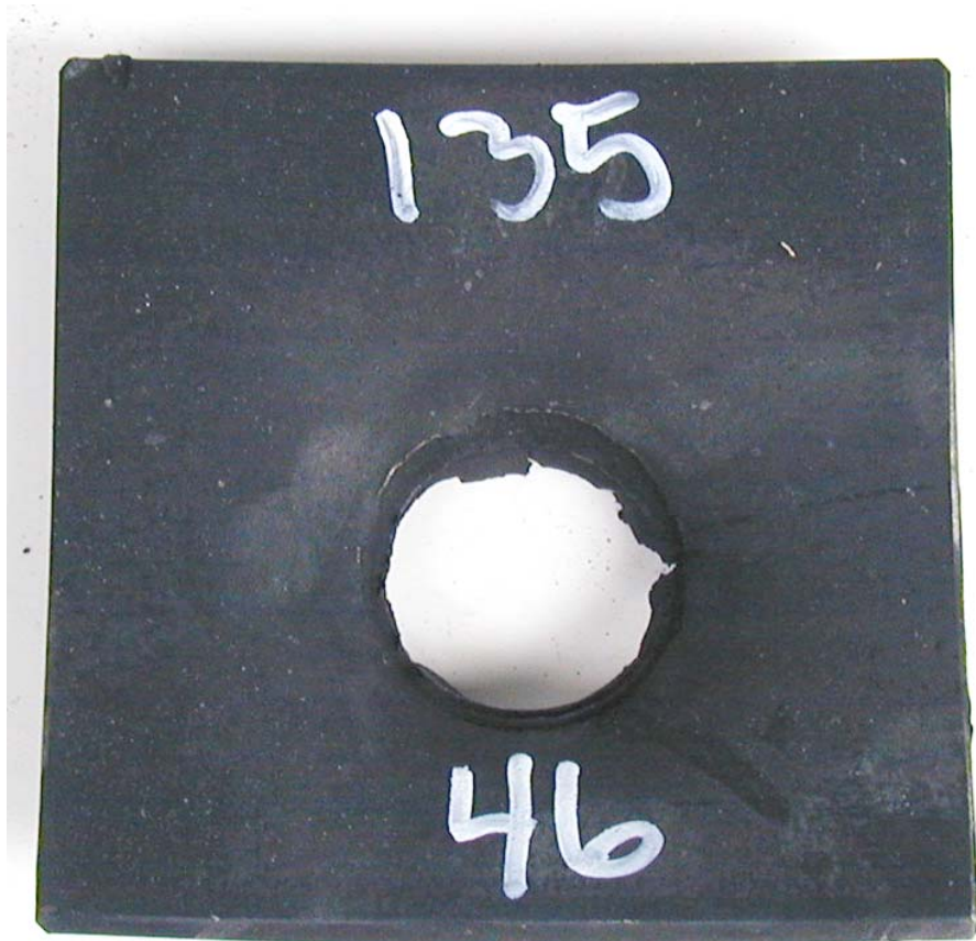
Figur 3.12 Skudd 9, rør 46 fylt med PBXN-110C, 135 kort, omsatt.
