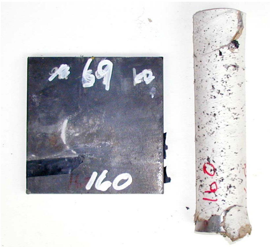
Figur 3.4 Skudd 1, rør 69 fylt med PBXN-110, 160 kort, ikke omsatt.
