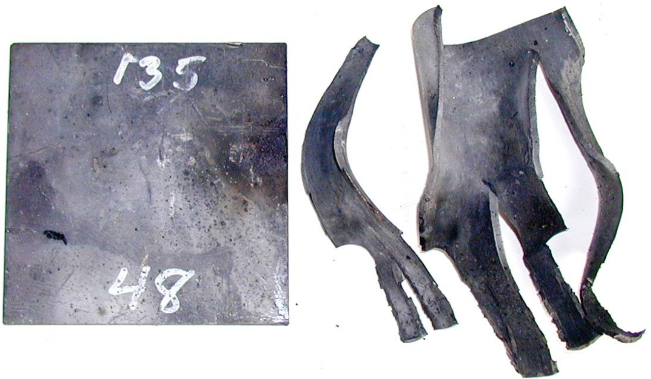
Figur 3.10 Skudd 7, rør 48 fylt med PBXN-110C, 135 kort, ikke omsatt.
