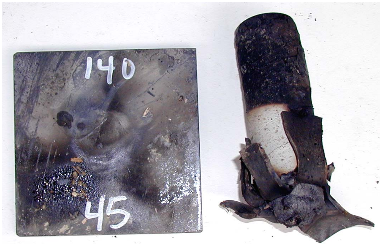
Figur 3.13 Skudd 10, rør 45 fylt med PBXN-110C, 140 kort, ikke omsatt.
