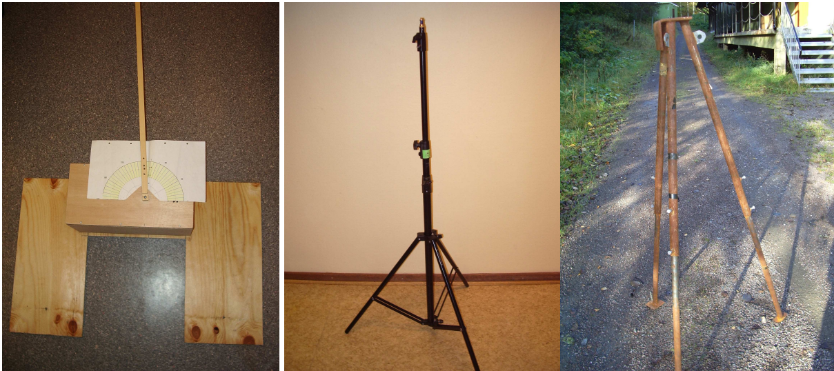
Figur 3.7 Venstre: Stativ for å rette inn sensoren rett mot sentrum av munningen på løpet. Stativet har en gradskive som tillater måling av vinkelen innenfor omtrent en grads nøyaktighet. Midten: Stativ for Norsonic 121, lånt fra FB. Høyre: Stativ (2 stykker) brukt til PCB 137 sensoren. Lånt fra FB.
