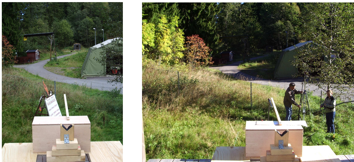
Figur 3.3 Stativets legges i plan mot målet. Til høyre ser vi sensoren som står på 6.9 m.
