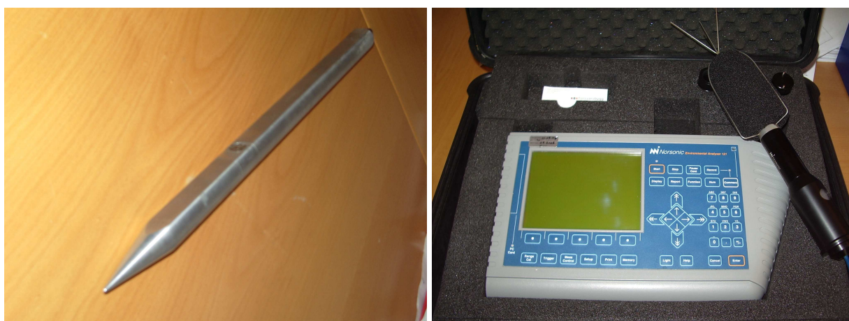
Figur 3.6 Venstre: “Pencil blast sensor” av typen PCB 137A23. Selve sensoren sees på siden av sensorhuset. Høyre: Norsonic environmental analyzer 121.
