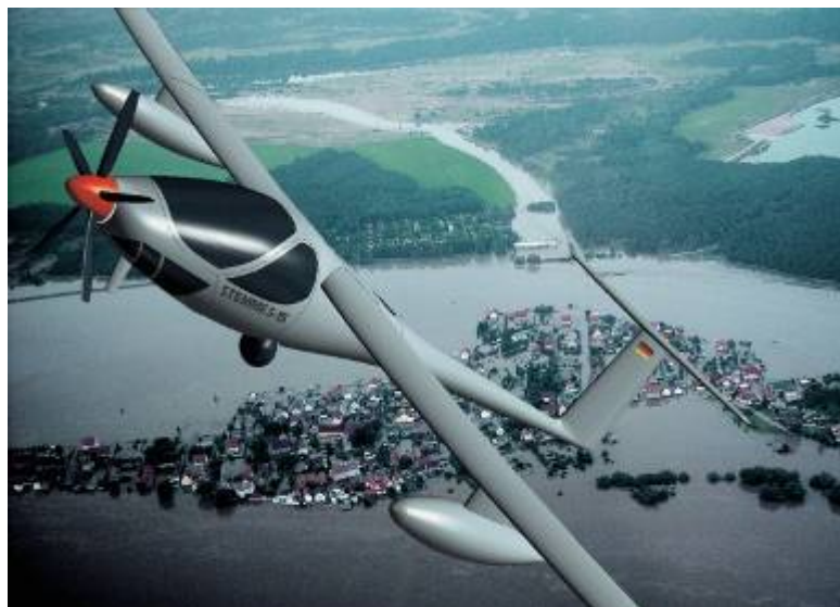
Figur 10.1 Fly som Stemme S-15 er konstruert for å operere med eller uten pilot avhengig av oppdrag. Slike løsninger kan gjøre overgangen til UAS lettere.
