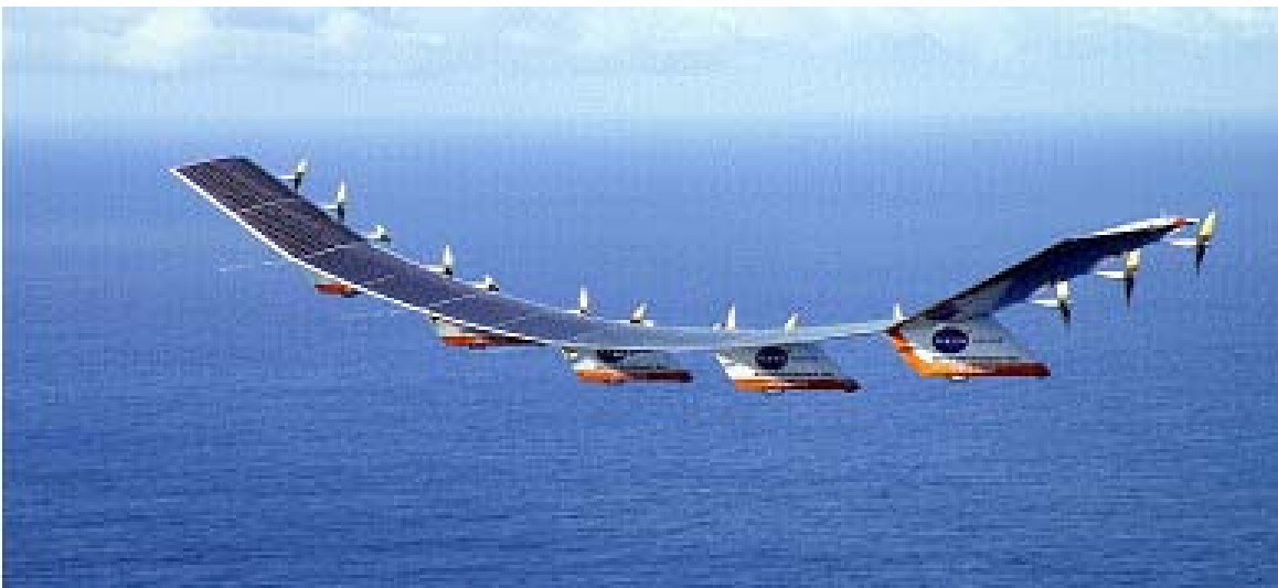
Figur 5.1 Den eksperimentelle Helios brukte brenselceller og solceller. Flere andre prosjekter eksperimenterer med brenselceller i mindre farkoster.
