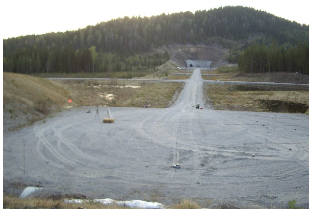
Figur 4.3: Standplass sett bakfra. Kulverten er i enden av veien. Det ble skutt omtrent midt på veggen.
