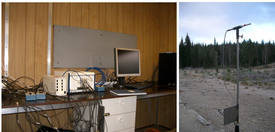
Figur 5.4: Venstre: Datainnsamlingsutstyret. Fra venstre på bildet: To PCB batteridrevne forsterkere, en 8-kanals PCB forsterker, PXI-chassiet, PC med kort for å kommunisere med PXI-chassiet. Høyre: Stativ for sensorer på 20 m. Øverst mikrofon fra Brüel & Kjær. Nederst sensor av typen PCB 106B plassert i en plate.
