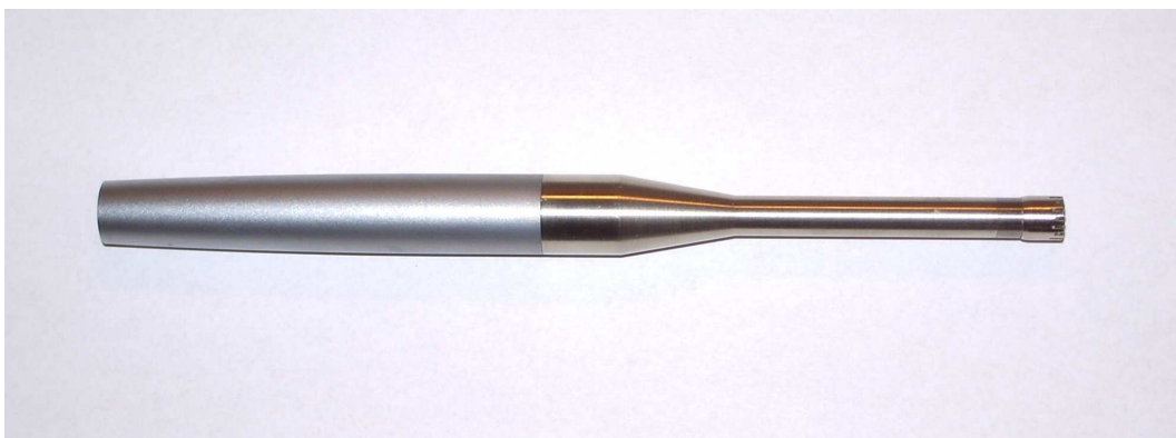
Figur 5.2: Mikrofon av typen Brüel & Kjær 4938 (1/4"), med mellomstykke UA0035 (fra 1/4" til 1/2") og forforsterker type 2669.
