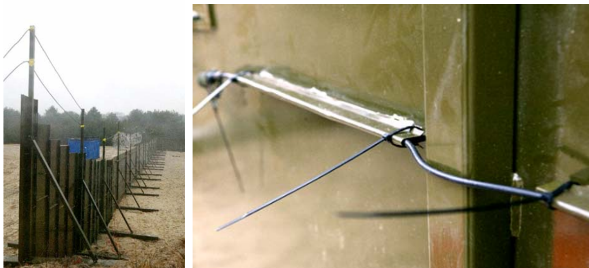
Figur 4.1 Pansret gjerde med lekkasjekabler (FSP-100, Auratek) på toppen (t.v.) og mikrofonkabel (Defensor, Geoquip) på baksiden av gjerdet (t.h.). Bilder fra forsøk med perimetersystem utviklet i RTP 3.24 (foto: WTD 91, Meppen, Tyskland).
