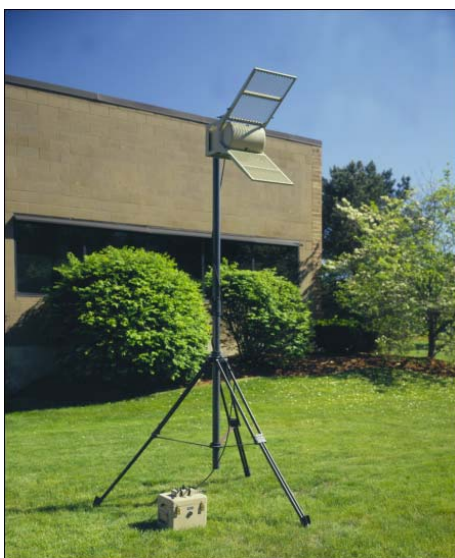
Figur 3.5 Monostatisk radar for perimeterovervåking (QUPID, Curtiss-Wright). Sensorene kan settes etter hverandre langs perimeteren for å gi en sammenhengende deteksjonssone, som vist i skissen til høyre.
