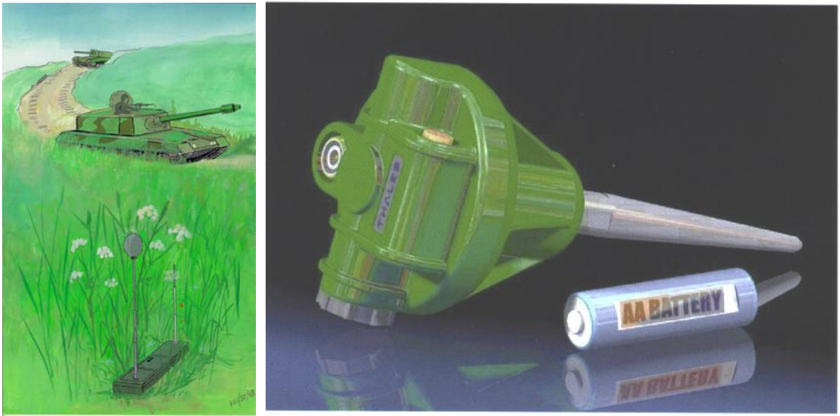
Figur 2.2 Eksempler på marksensorer. Bildet til venstre er en skisse av en akustisk marksensor for deteksjon og klassifisering av stridskjøretøyer (FFI). Bildet til høyre viser en seismisk marksensor (den kan også bruke en magnetisk sensor eller en passiv IR-detektor i tillegg) som er spesielt utviklet med tanke på sikring av midlertidige leiområder og feltstillinger (Thales). Denne sensoren er først og fremst beregnet for deteksjon av inntrengere til fots, men vil også kunne detektere kjøretøyer.
