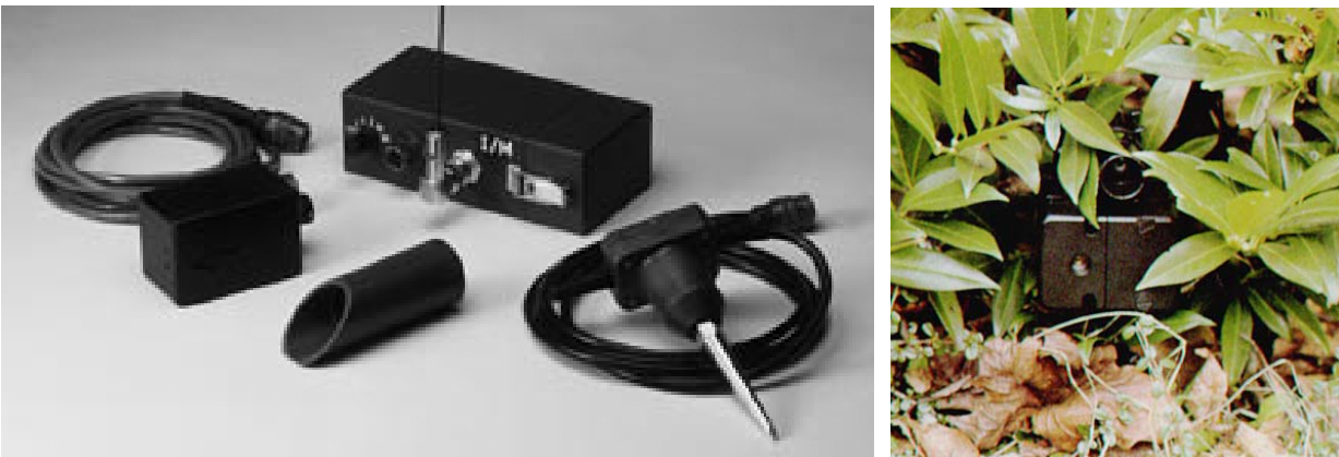
Figur 4.3 Marksensorysystemet EIDS (Eagle Intrusion Detection System, Eagle Telonics). Bildet til venstre viser sensorenheten (bakerst) og de tre sensortypene som kan kobles til enheten, hhv. magnetometer (til venstre), PIR-detektor (i midten) og geofon (til høyre). Bildet til høyre viser infrarød detektor kamouflert av vegetasjon.
