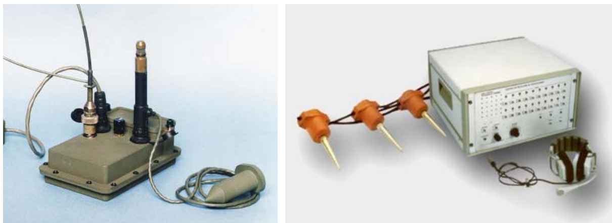
Figur 3.1 Eksempler på seismiske sensorsystemer; marksensor med geofon (IDEWS, L-3 Communications) til venstre og perimetersensor med geofonkjede til høyre.
