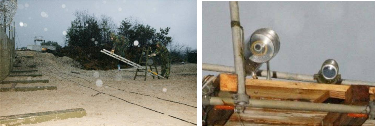
Figur 4.2 Overvåkingsgate på utsiden av gjerdet i figur 4.1, med lekkasjekabler på bakken og overvåkingskamera og PIR-detektor på plattform i bakgrunnen. I bildet til venstre gjør to soldater et mislykket forsøk på å forsere overvåkingsgaten. Nærbilde av kamera og PIR-detektor til høyre (foto: WTD 91, Meppen, Tyskland).
