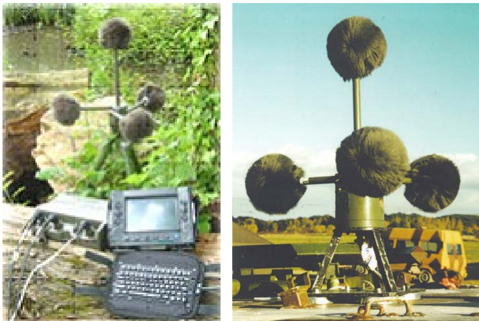
Figur 3.2 Luftakustisk sensor for deteksjon og posisjonsbestemning av snikskytttere; bakkebasert system til venstre og mikrofonantenne montert på taket av pansret kjøretøy i bildet til høyre (PILAR, Metravib).
