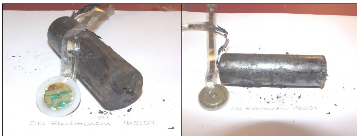
Figur 3.14 viser utbrent DD Li/SO 2 Cl 2 , CSC93. Fra a) sees det tydelig et hull som sannsynligvis er en del av det som utgjør sikkerhetsventilen. Lokket med beskyttelseskrets har hoppet av. Fra b) ser man at begge endene buler noe ut.
