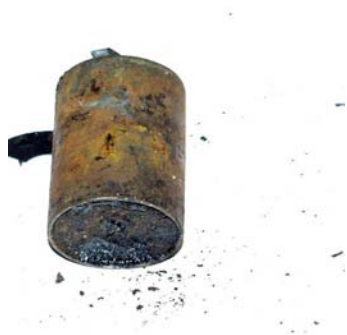
Figur 3.31, cellen etter testing, ICR34600.
