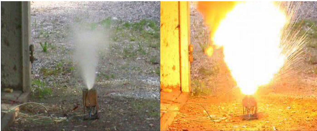
Figur 3.16, cellen ventilerer og brenner omtrent samtidig. Det er ca. 9/25 -dels sekund mellom bildene, CSC93.
