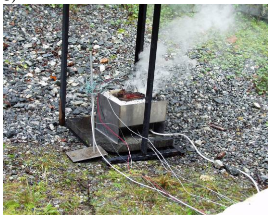
Figur 3.34 , a) plassering av termoelement under batteriet b) batteriklossen på plass i ovnen med silikonolje rundt c) tatt 5 minutter etter at ventileringen har funnet sted.
