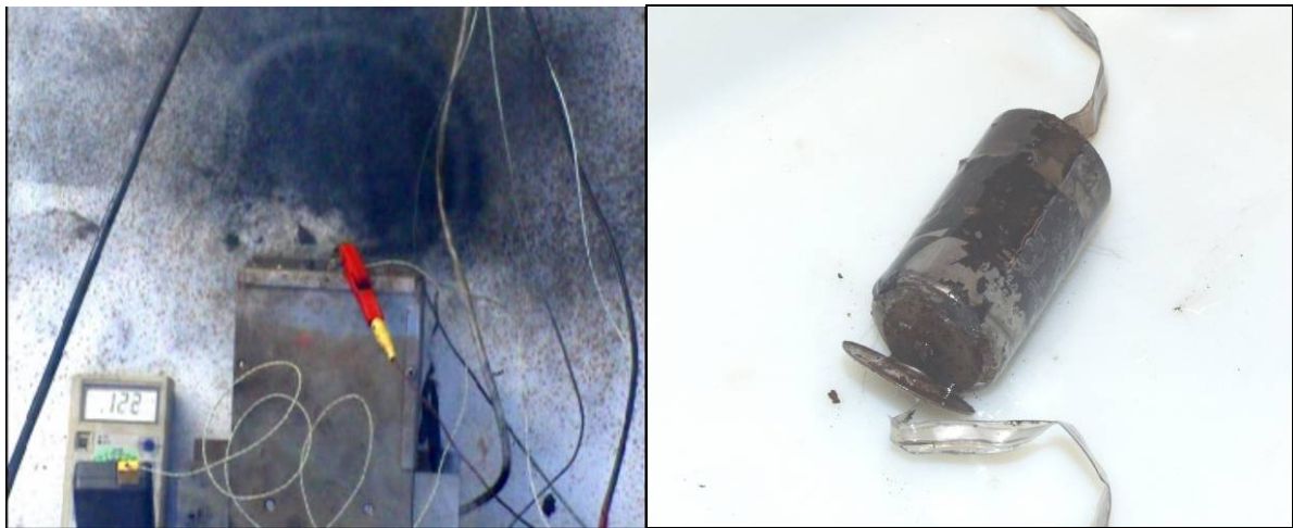
Figur 3.23, a) tatt fra videoen da cellen ventilerer. Ingen synlig røyk. b) Det ene endelokket på cellen har åpnet seg. Ellers virker cellen intakt.
