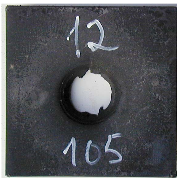
Figur 3.5 Skudd 2, rør 12 med PBXN-109 aldret i 12 mnd ved 60°C, 105 kort, omsatt.
