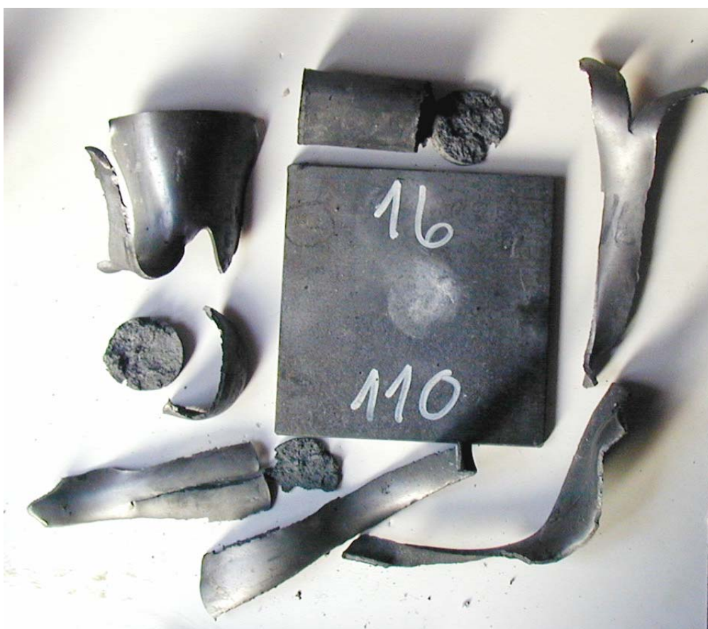
Figur 3.9 Skudd 6, rør 16 aldret i 12 mnd ved 60°C med PBXN-109, 110 kort, ikke omsatt.
