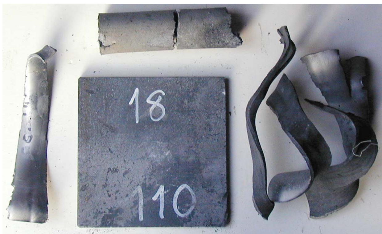
Figur 3.11 Skudd 8, rør 18 aldret i 12 mnd ved 60°C med PBXN-109 RS-RDX Ch. 719/03 v.78, 110 kort, ikke omsatt.
