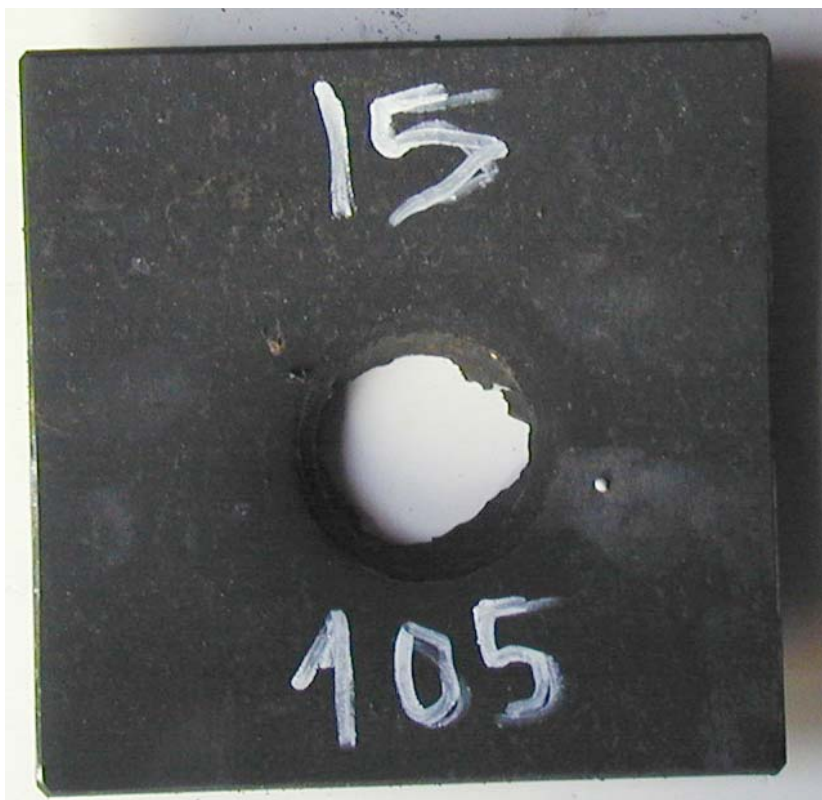
Figur 3.8 Skudd 5, rør 15 aldret i 12 mnd ved 60°C med PBXN-109 RS-RDX Ch. 719/03 v.78, 105 kort, omsatt.
