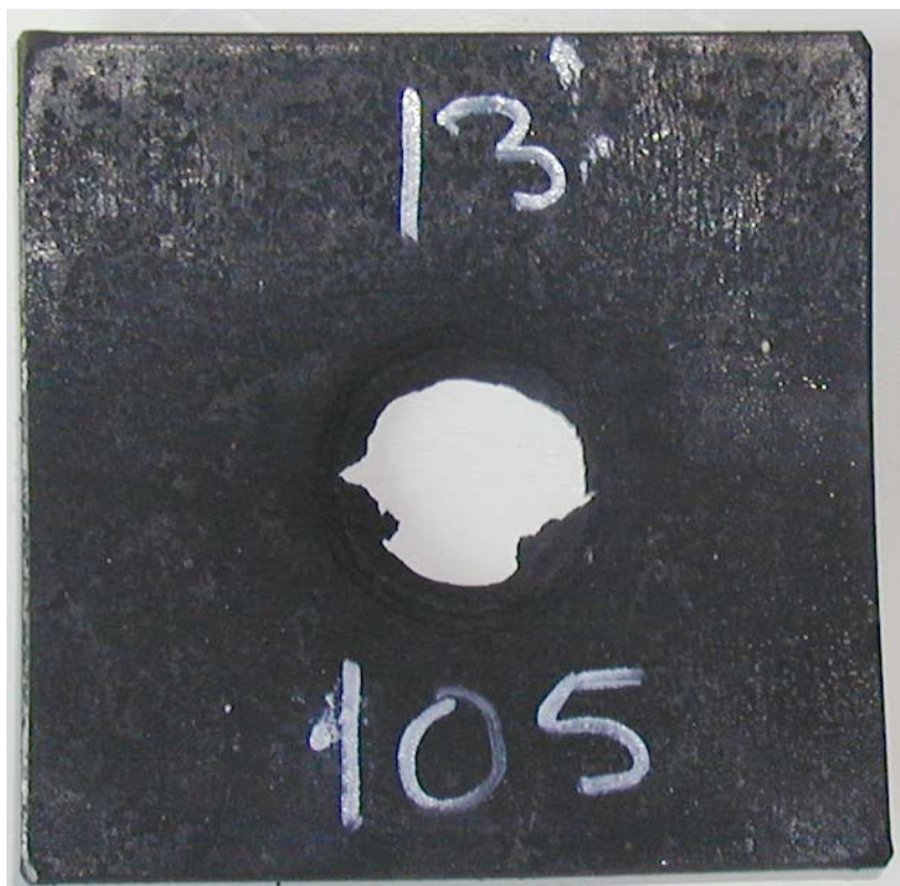
Figur 3.6 Skudd 3, rør 13 med PBXN-109 aldret i 12 mnd ved 60°C, 105 kort, omsatt.
