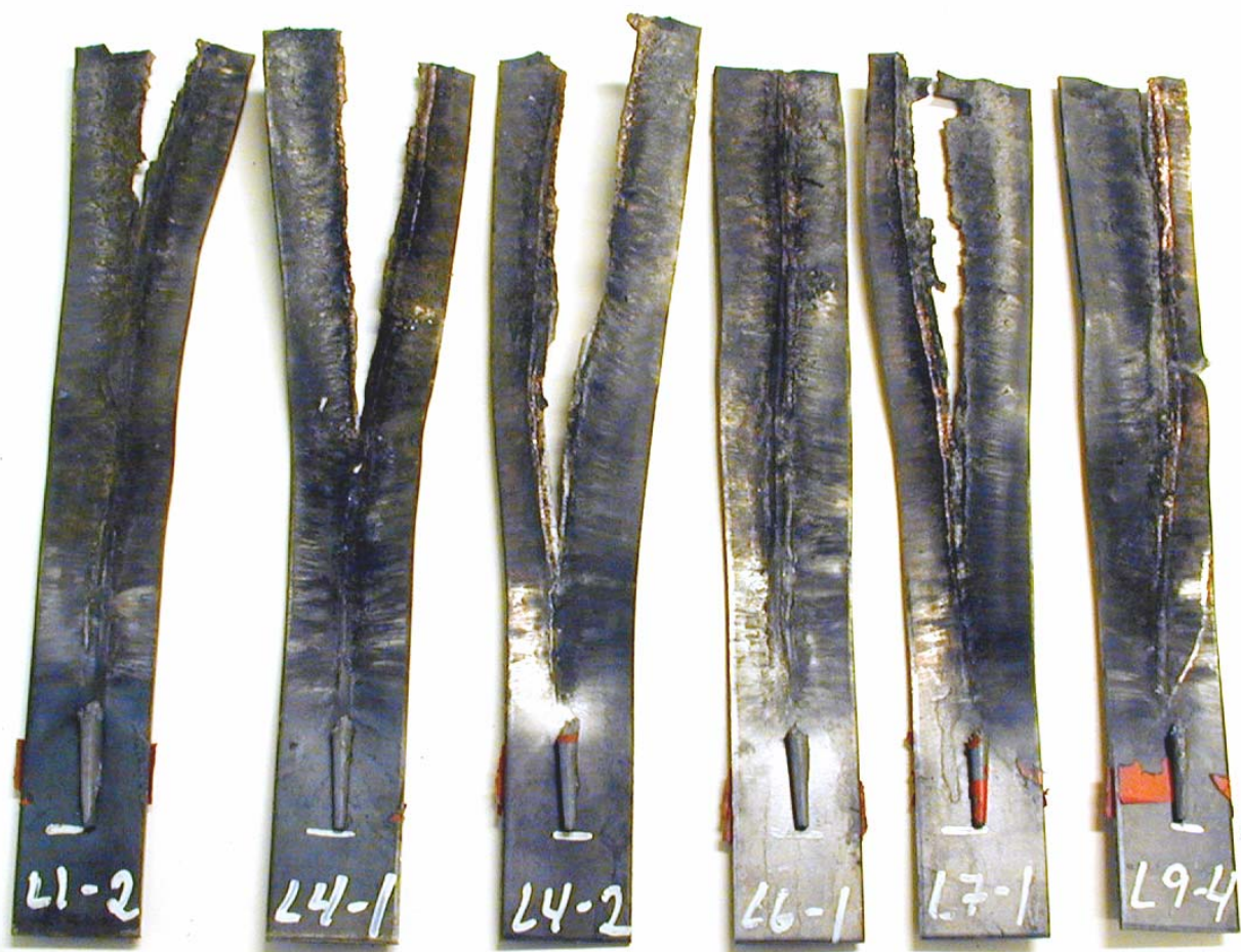
Figur 3.2 Vitneplater og rester av sprengstoffkoner etter omsetning av skuddene.
