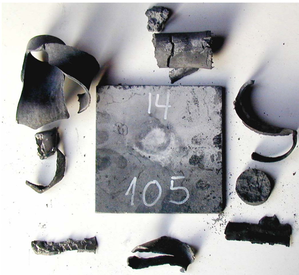
Figur 3.7 Skudd 5, rør 14 med PBXN-109 aldret i 12 mnd ved 60°C, 105 kort, ikke omsatt.
