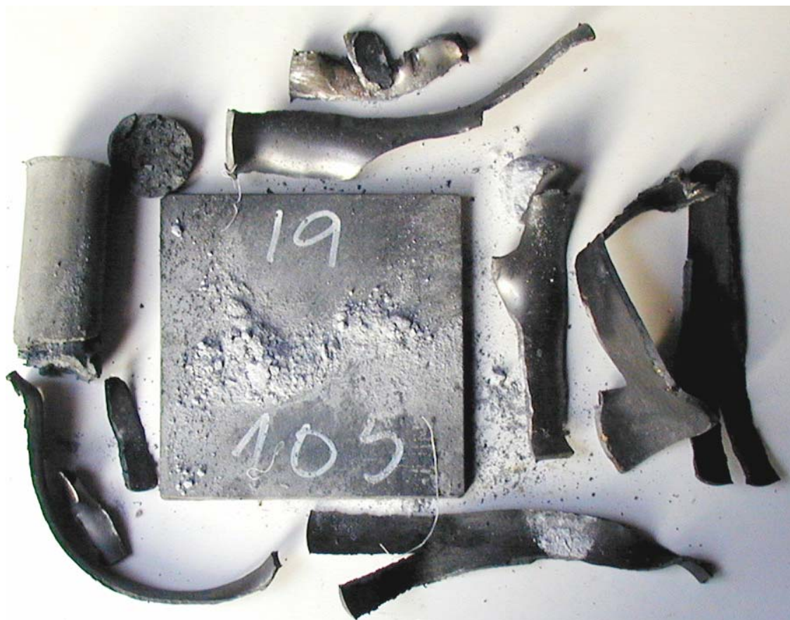
Figur 3.12 Skudd 9, rør 19 aldret i 12 mnd ved 60°C med PBXN-109, 105 kort, ikke omsatt.
