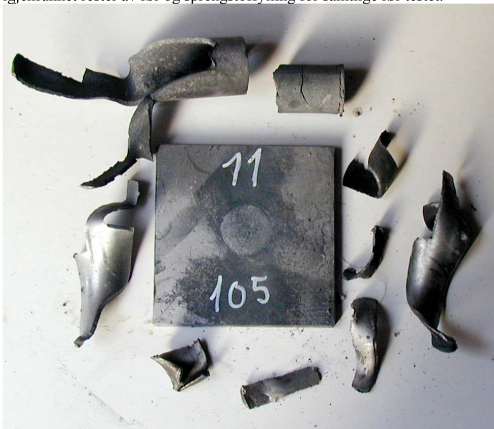
Figur 3.4 Skudd 1, rør 11 med PBXN-109 aldret i 12 mnd ved 60°C, 105 kort, ikke omsatt.
