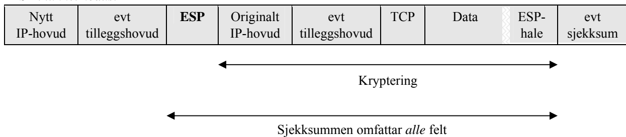
Figur 5.7 ESP i transport- og tunnelmodus
