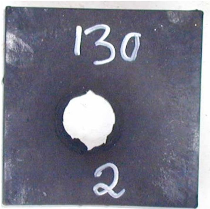
Figur 3.6 Skudd 2, rør 2 med PBXN-110, barrieretykkelse 130 kort, omsatt.
