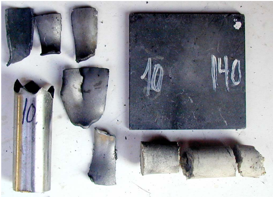
Figur 3.14 Skudd 10, rør 10 med PBXN-110, barrieretykkelse 140 kort, ikke omsetning.
