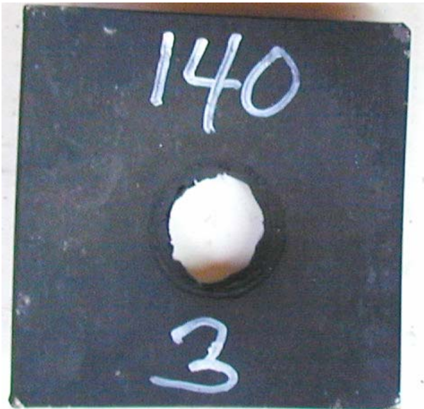
Figur 3.6 Skudd 2, rør 2 med PBXN-110, barrieretykkelse 130 kort, omsatt.
