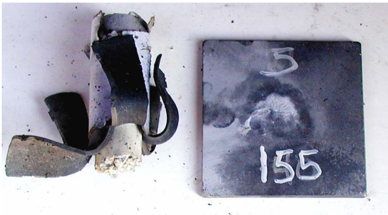
Figur 3.9 Skudd 5, rør 5 med PBXN-110, barrieretykkelse 155 kort, ikke omsetning.
