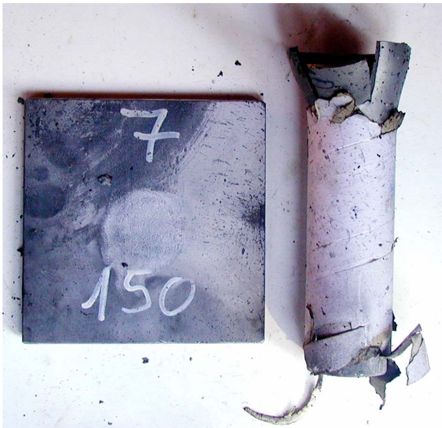
Figur 3.11 Skudd 7, rør 7 med PBXN-110, barrieretykkelse 150 kort, ikke omsetning.
