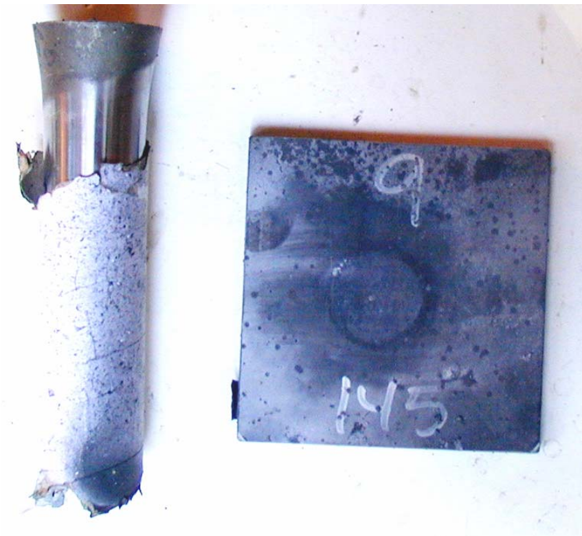
Figur 3.13 Skudd 9, rør 9 med PBXN-110, barrieretykkelse 145 kort, ikke omsetning.
