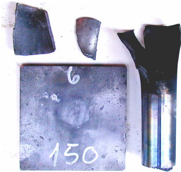
Figur 3.10 Skudd 6, rør 6 med PBXN-110, barrieretykkelse 150 kort, ikke omsetning.
