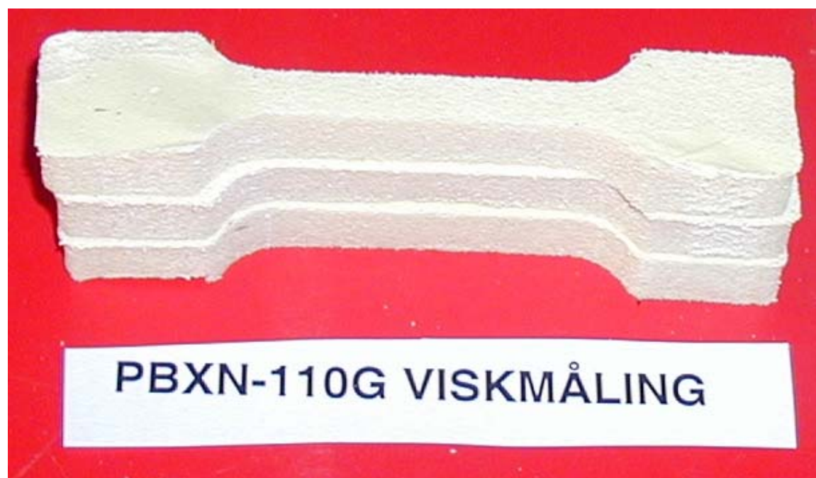
Figur 3.24 Dogbones fra massen benyttet til viskositetsmålinger før strekking.
