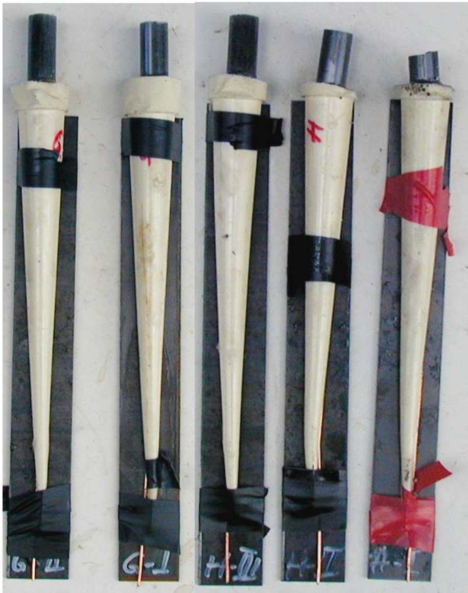
Figur 3.16 Ladninger for bestemmelse av kritisk diameter etter de var montert på vitneplater.
