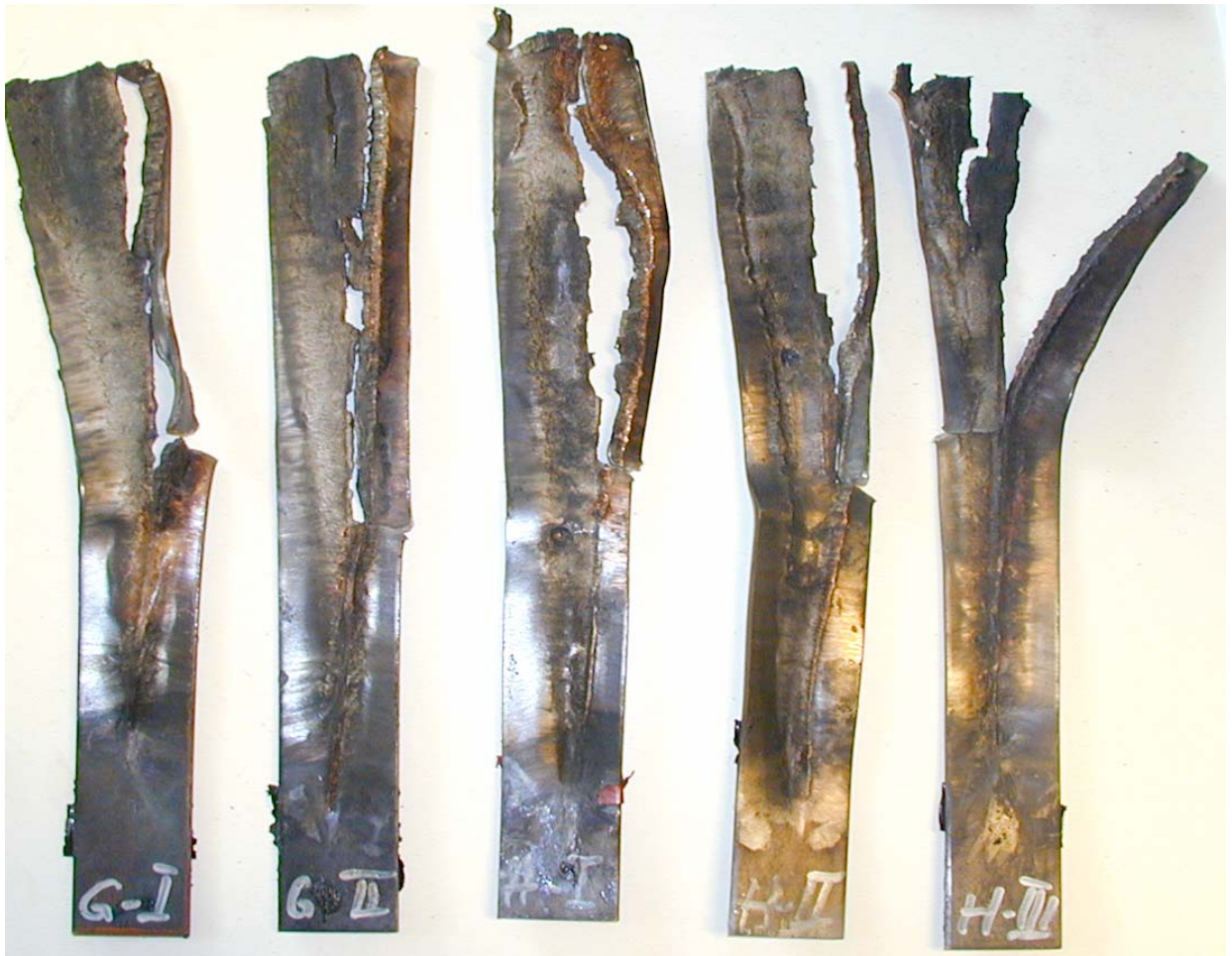
Figur 3.17 Vitneplater fra fyringer for bestemmelse av kritisk diameter.
