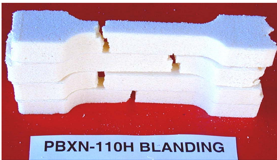
Figur 3.28 Bildet viser dogbones fra PBXN-110 H støpen etter strekking.
