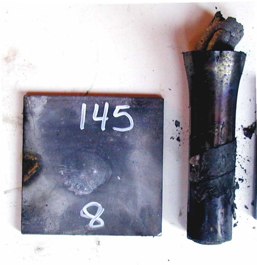
Figur 3.12 Skudd 8, rør 8 med PBXN-110, barrieretykkelse 145 kort, ikke omsetning.
