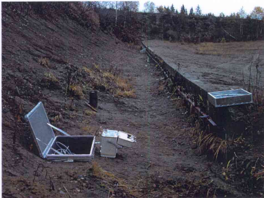
Figur 3.5 Feltutrustning plassert på skytebane 6. Nedgravd aluminiumskasse med vakuumpumpe og prøveflasker. TDR instrumentet som ble brukt til jordfuktighetsmåling er stående til høyre for kassen. Bak kassen vises foringsrøret til grunnvannsbrønnen
