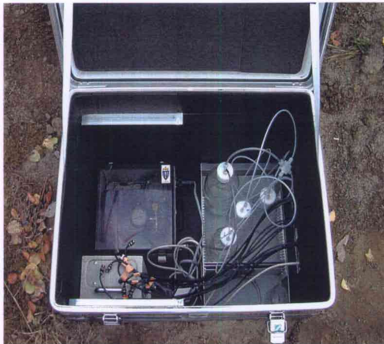
Figur 3.7 Lysimeteranlegget på Sessvollmoen. T.v bak i kassen er vakumpumpen, mens til t.v vises tidstyringsenhet. T.h vises prøvetakningsflaskene for jordvæskesugere
