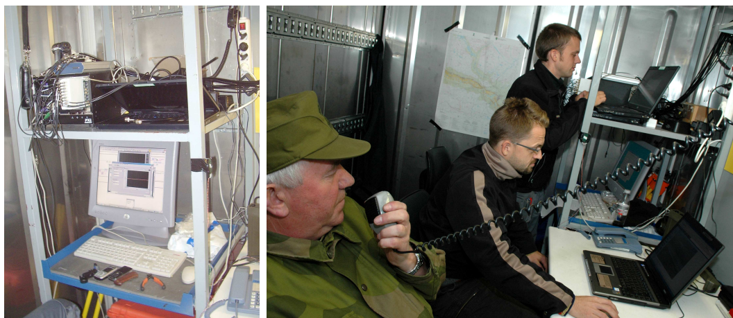
Figur 5.3: Venstre: PXI-chassiet oppe til venstre. Høyre: Måleoppsett innerst i brakka sammen med standplassledelsen.
