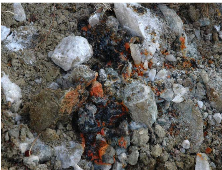
Figur 3.3 Hvitt fosfor som sannsynligvis er omdannet til rødt og svart fosfor
