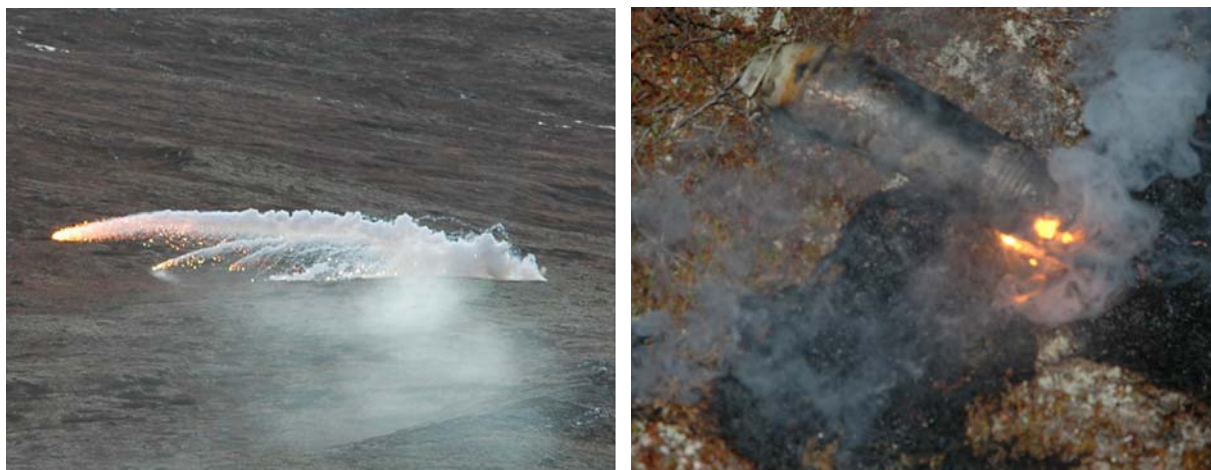
Figur 3.7 BK-grenater med anslagsbrannrør som ikke detonerte. Til venstre en BK-grenat som spratt flere titalls meter etter treff og som ved treff sannsynligvis er blitt revet opp slik at innholdet av hvitt fosfor antente. Til høyre en BK-grenat som har fått brannrøret avslått og der en kan se at innholdet av hvitt fosfor brenner inne i granaten
