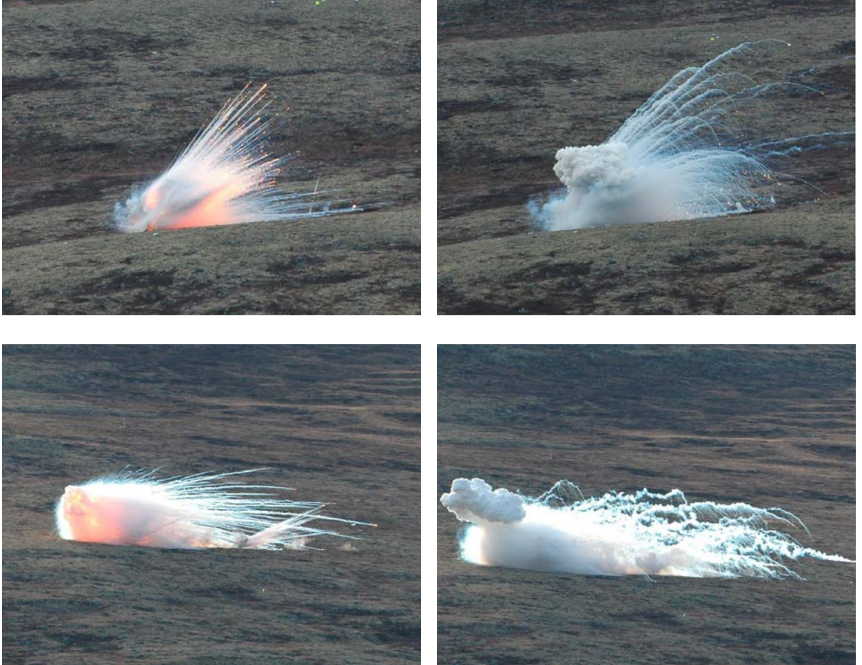
Figur 3.4 Bilder av artillerigranater med anslagsbrannrør (over) og nærhetsbrannrør (under) tatt i detonasjonsøyeblikket (til venstre) og 2-3 sekunder etter detonasjonen (til høyre)
