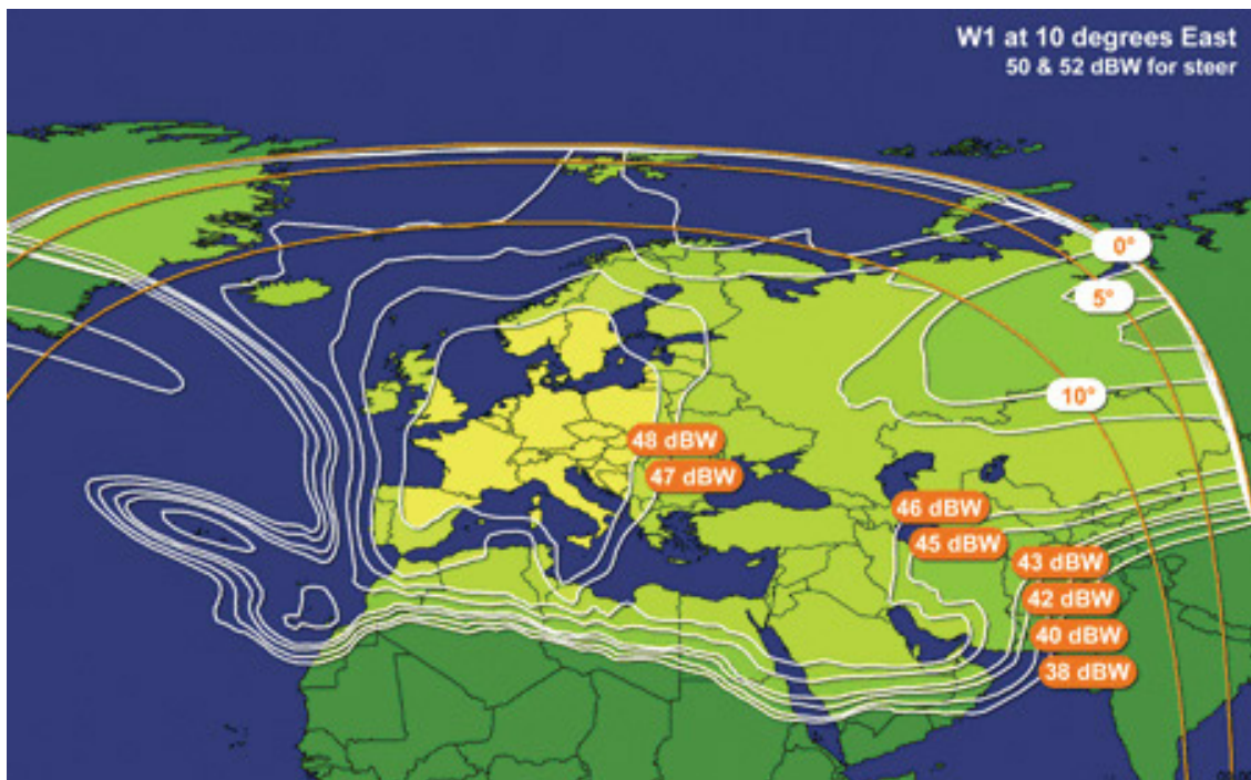
Figur 3.17 Den europeiske kommunikasjonssatellitten EUTELSAT's dekning av Europa. Kotene viser signalnivået, som er sterkest over midten av Vest-Europa, og som faller utover i området
