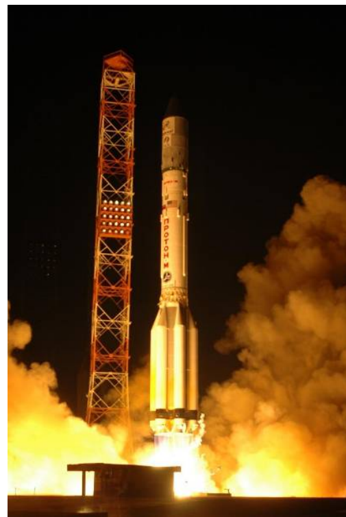
Figur 2.14 En bærerakett starter ferden for å bringe en satellitt i bane.
