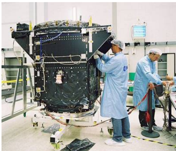
Figur 3.20 En Galileo satellitt under bygging
