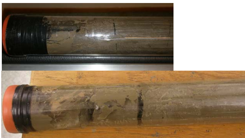
Figur 2.4 To eksempler på dårlig fylling og sprekker i sedimentet. Foto fra Universitetet i Bergen.
