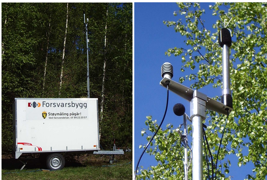
Figur 2.1: FFI sine mikrofoner festet på mobil-b under målingene på Deset 28/5-2008.
