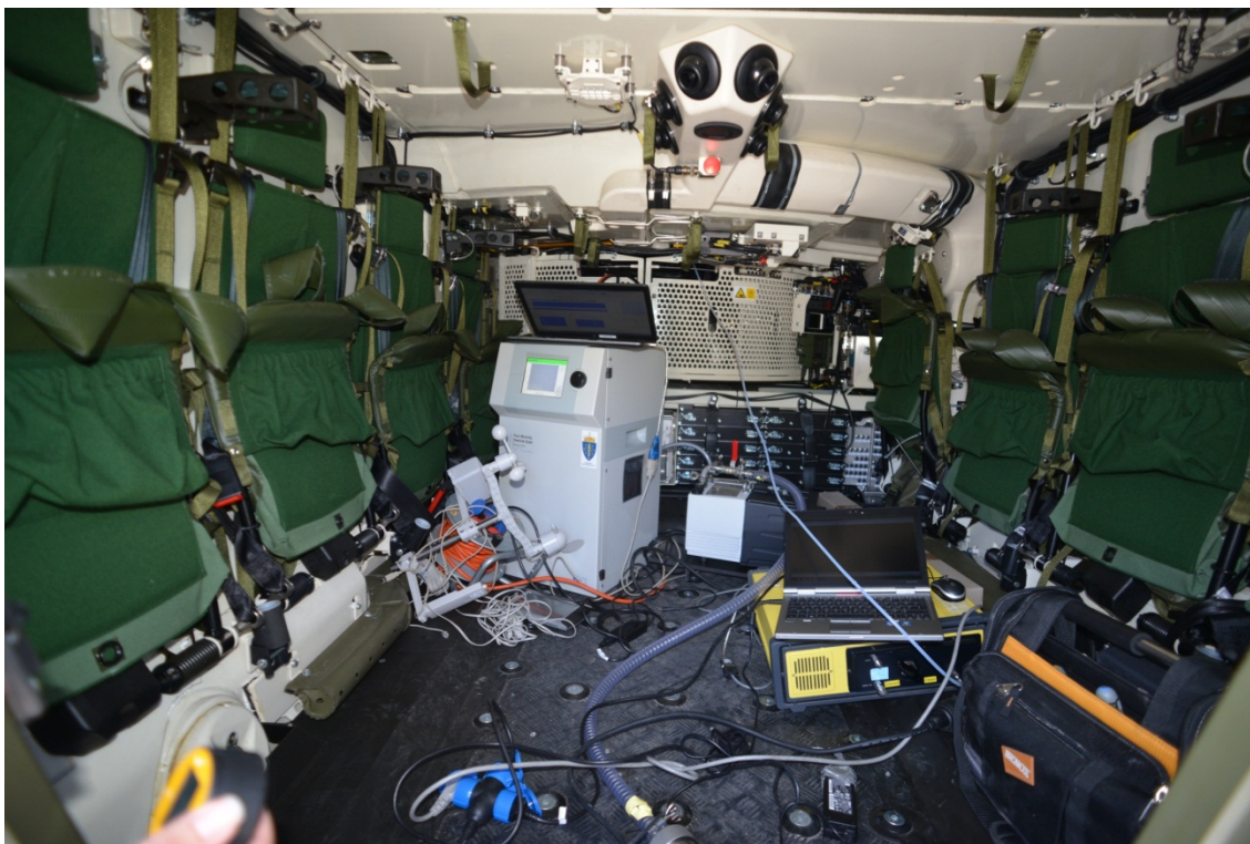
Figur 2.6 Oppsett av FMPS, Gasmeter og kaskadeimpaktor (fra venstre mot høyre) inne i stridsrommet til CV90. Prøvetakingslanger er trukket derfra og inn til skytters innåndingssone (Figur 2.7).
