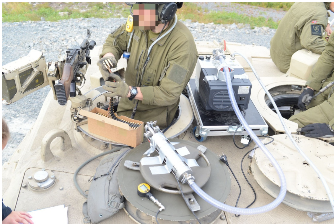
Figur 2.1 Plassering av måleinstrumenter på personell og taket av Leo2 under måling i Regionfelt Østlandet på Rena den 8. september 2015.
