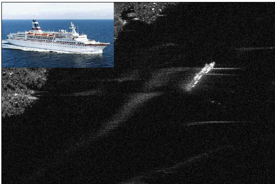
Figur 2.4 Cruiseskipet Astor (lengde 175 m) avbildet med TerraSAR-X, 2.0 x 1.7 m oppløsning (range x asimut). Skipet seiler med ca. 12 knops hastighet
