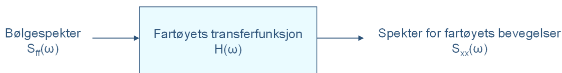
Figur 2.10 Sammenheng mellom havbølgespekteret og et fartøys bevegelser
