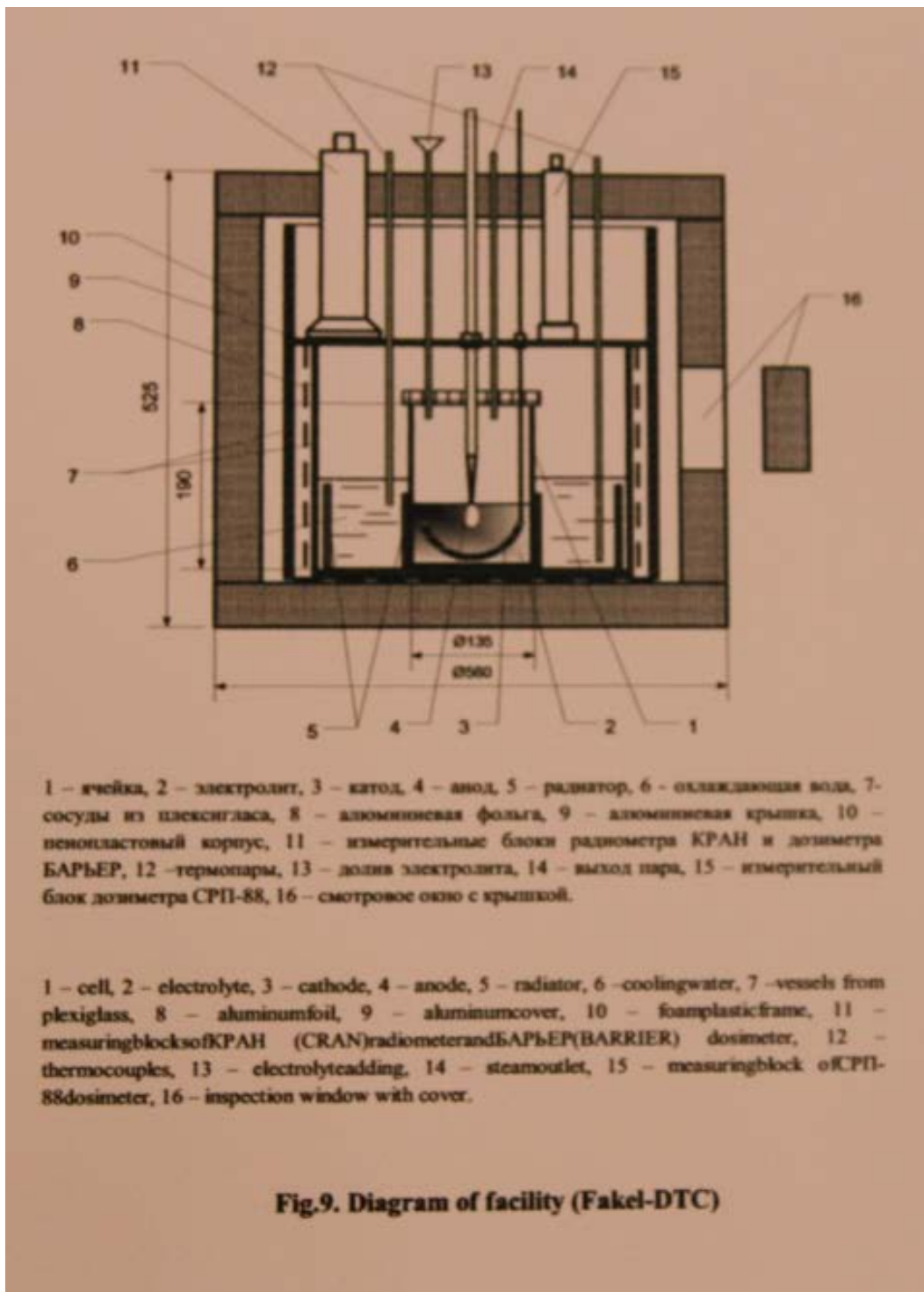
Figur 5.3 Plasma elektrolyse og kalorimetri. Fra Bazhutov et al, Poster ICCF-19. Enheten er utviklet for bruk ved demonstrasjoner i auditorium.
