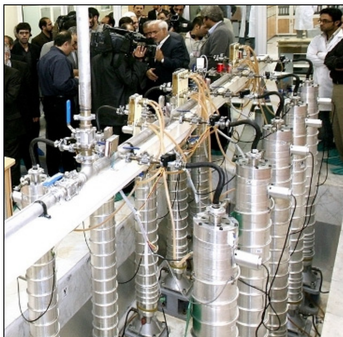
Figur 2.4 Eksperimentelle sentrifuger ved PFEP. Øverst: Trolig to IR-3-sentrifuger. Nederst: P-1-sentrifuger til venstre og en antatt mer avansert modell av ukjent designasjon til høyre. Sistnevnte framstår som noe tykkere enn P-1. Lengden ser ut til å være omtrent som for P-1, og den er dermed vesentlig lengre enn IR-2 og IR-3. [39] (Foto: Iran's Presidency Office Handout)
