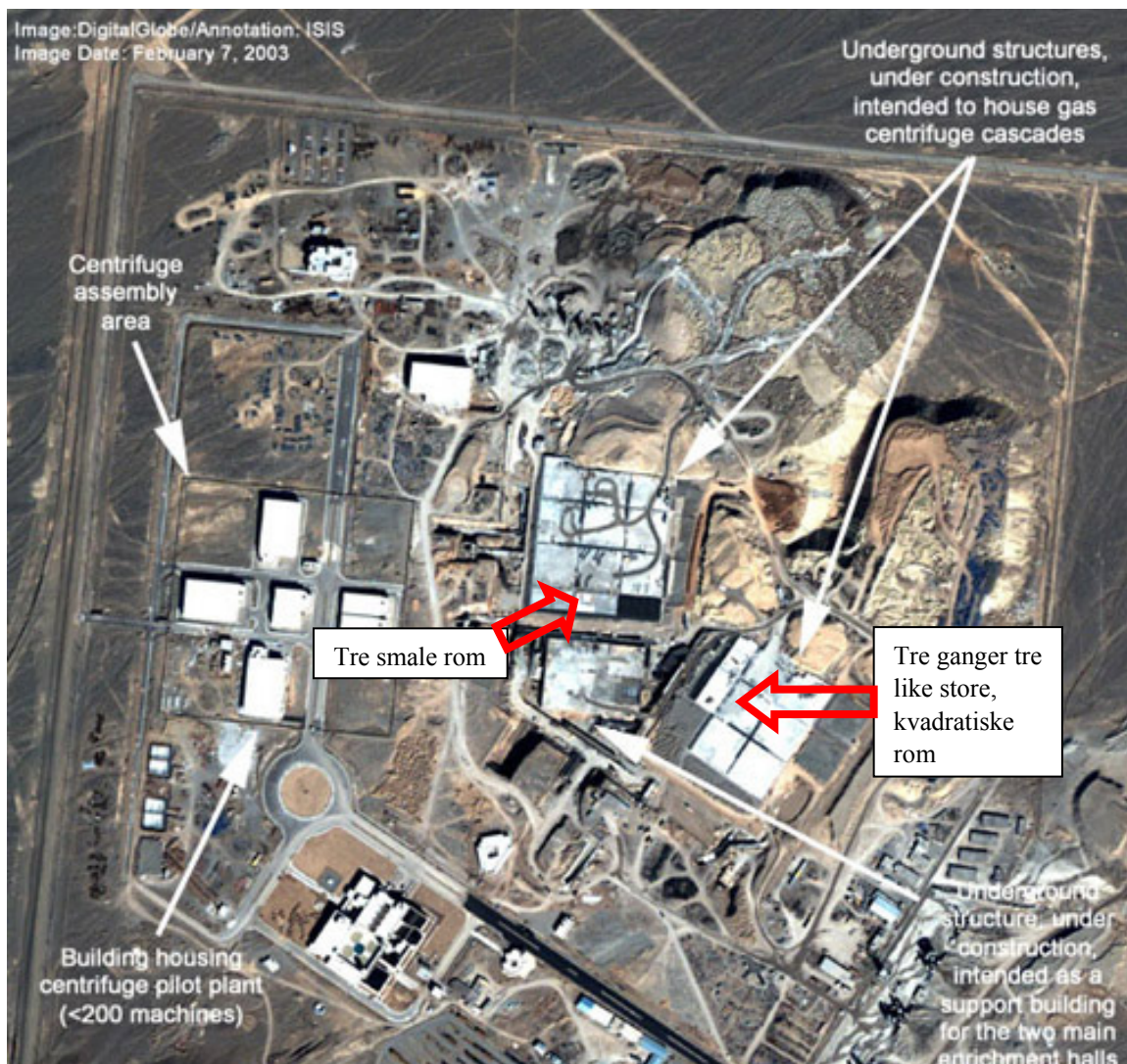
Figur 3.9 Kommersielt satellittbilde fra februar 2003, som viser to store undergrunnshaller som dekkes med betong. Begge hallene er delt inn i ni like store, kvadratiske rom på omkring 50 ganger 50 meter, pluss tre og tre langt smalere rom. (Foto: ISIS / Digital Globe)
