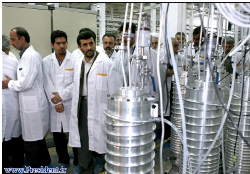
Figur 2.3 En testkaskade med IR-2-sentrifuger i PFEP. (Foto: Iran's Presidency Office Handout)
