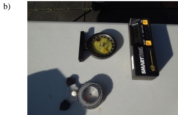
Figur 3.6 Testpersonenes maksimale mulige rotasjonen i overkroppen i stående stilling med strake bein og foroverbøyd overkropp måles (a). For å måle denne bevegelsen brukes det inklinometer og goniometer (b).
