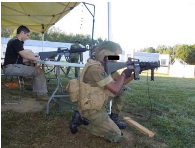
Figur 3.7 Sytesimulator (Noptel ST-2000) stasjon med en ptisk sensor montert på våpenet.
