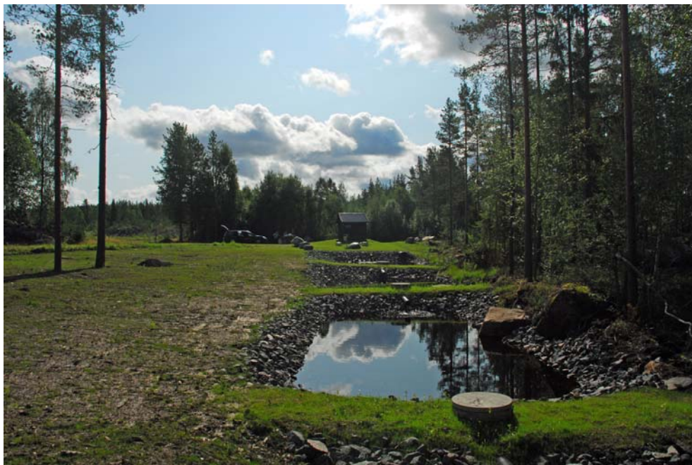
Figur 2.2 Pilotanlegg for testing av fellingskjemikalier som er etablert på Terningmoen skyte- og øvingsfelt ved bane 27. Bilde viser tre rensedammer og målehuset.
