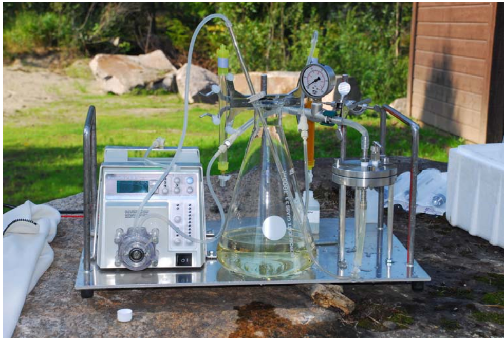
Figur 2.3 Utstyr som ble benyttet ved størrelses- og ladningsfraksjonering av vann.
