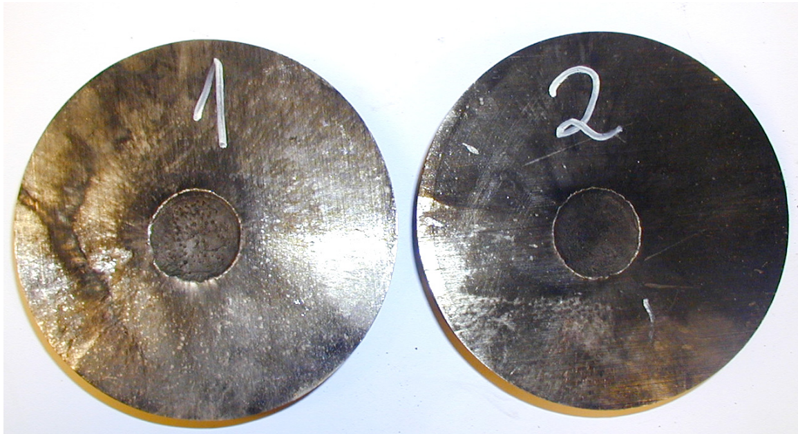
Figur 3.18 Bilde av Dent vitneplatene for skudd 1 og 2 med henholdsvis PBXN-110 B og A.
