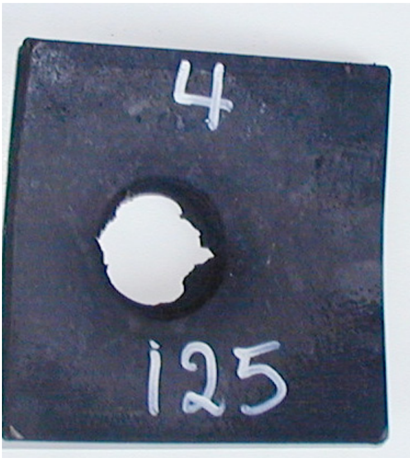
Figur 3.6 Skudd 4, rør 4 med PBXN-110 A, barrieretykkelse 125 kort, full omsetning.
