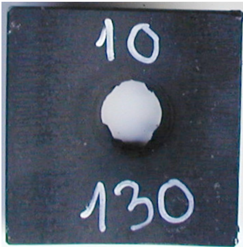
Figur 3.12 Skudd 10, rør 10 med PBXN-110 B, barrieretykkelse 130 kort, full omsetning.
