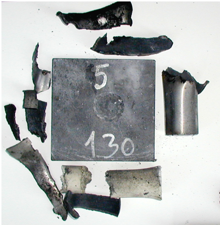
Figur 3.7 Skudd 5, rør 5 med PBXN-110 A, barrieretykkelse 130 kort, ikke omsetning.
