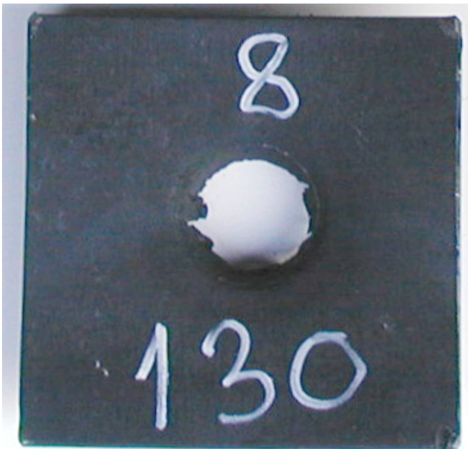
Figur 3.9 Skudd 7, rør 7 med PBXN-110 B, barrieretykkelse 130 kort, full omsetning.
