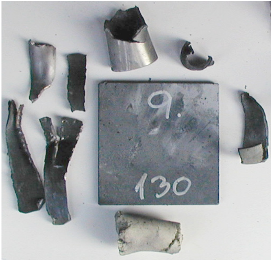
Figur 3.11 Skudd 9, rør 9 med PBXN-110 B, barrieretykkelse 130 kort, ikke omsetning.
