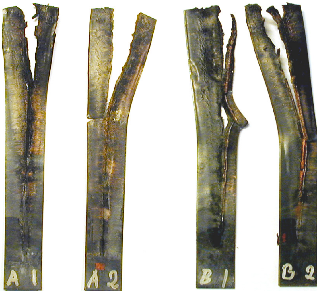
Figur 3.15 Vitneplater fra fyingene for bestemmelse av kritisk diameter.
