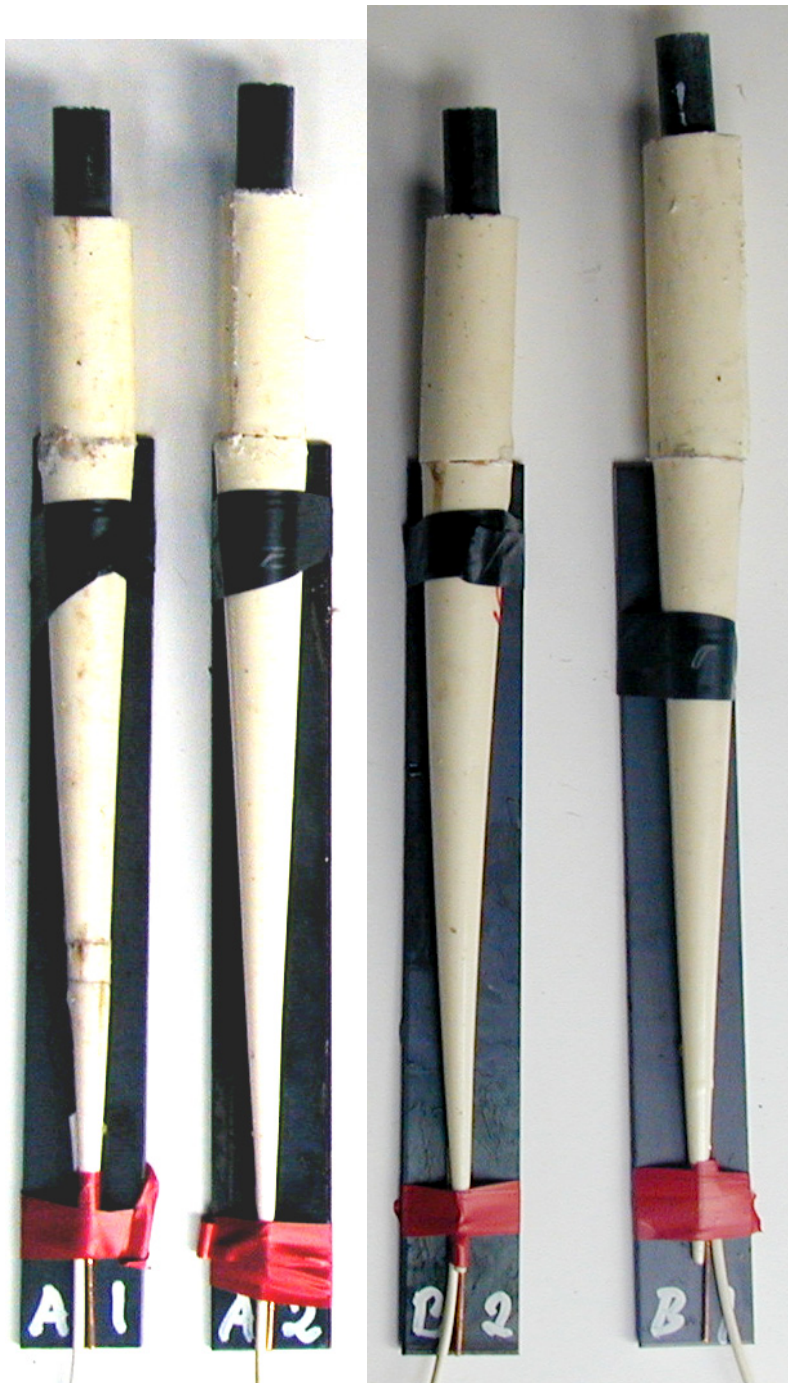
Figur 3.14 Ladningene for bestemmelse av kritisk diameter etter at de var montert på vitneplater.
