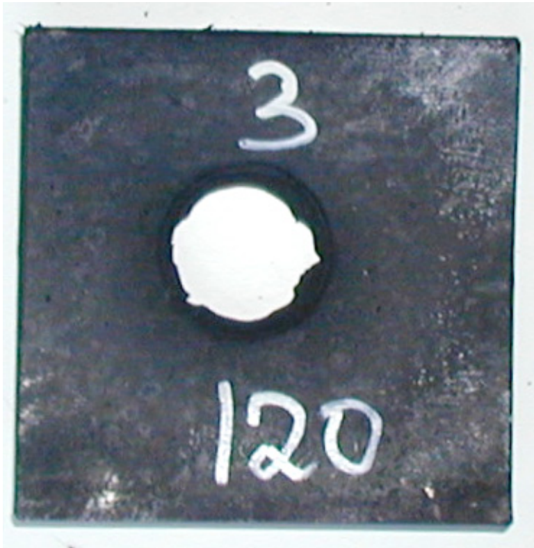
Figur 3.5 Skudd 3, rør 3 med PBXN-110 A, barrieretykkelse 120 kort, full omsetning.
