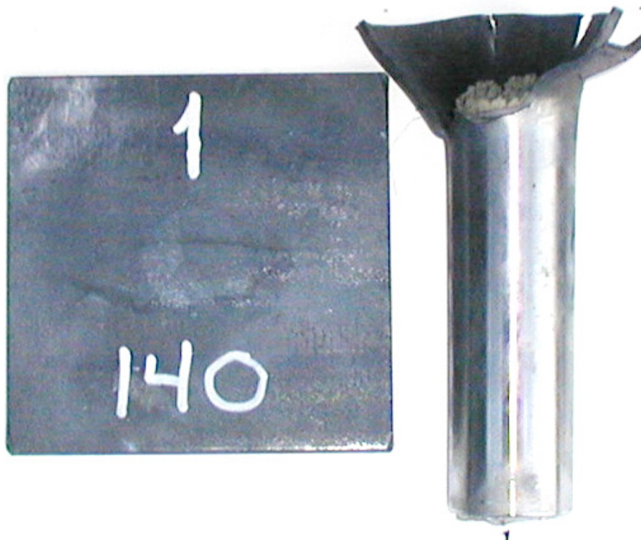
Figur 3.3 Skudd 1, rør 1 med PBXN-110 A, barrieretykkelse 140 kort, ikke omsetning.
