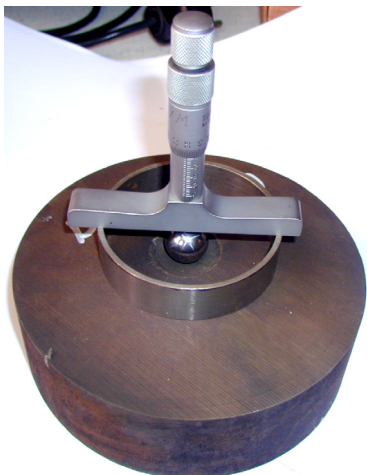
Figur 2.2 Bilde av oppsett for måling av dent dybde.
