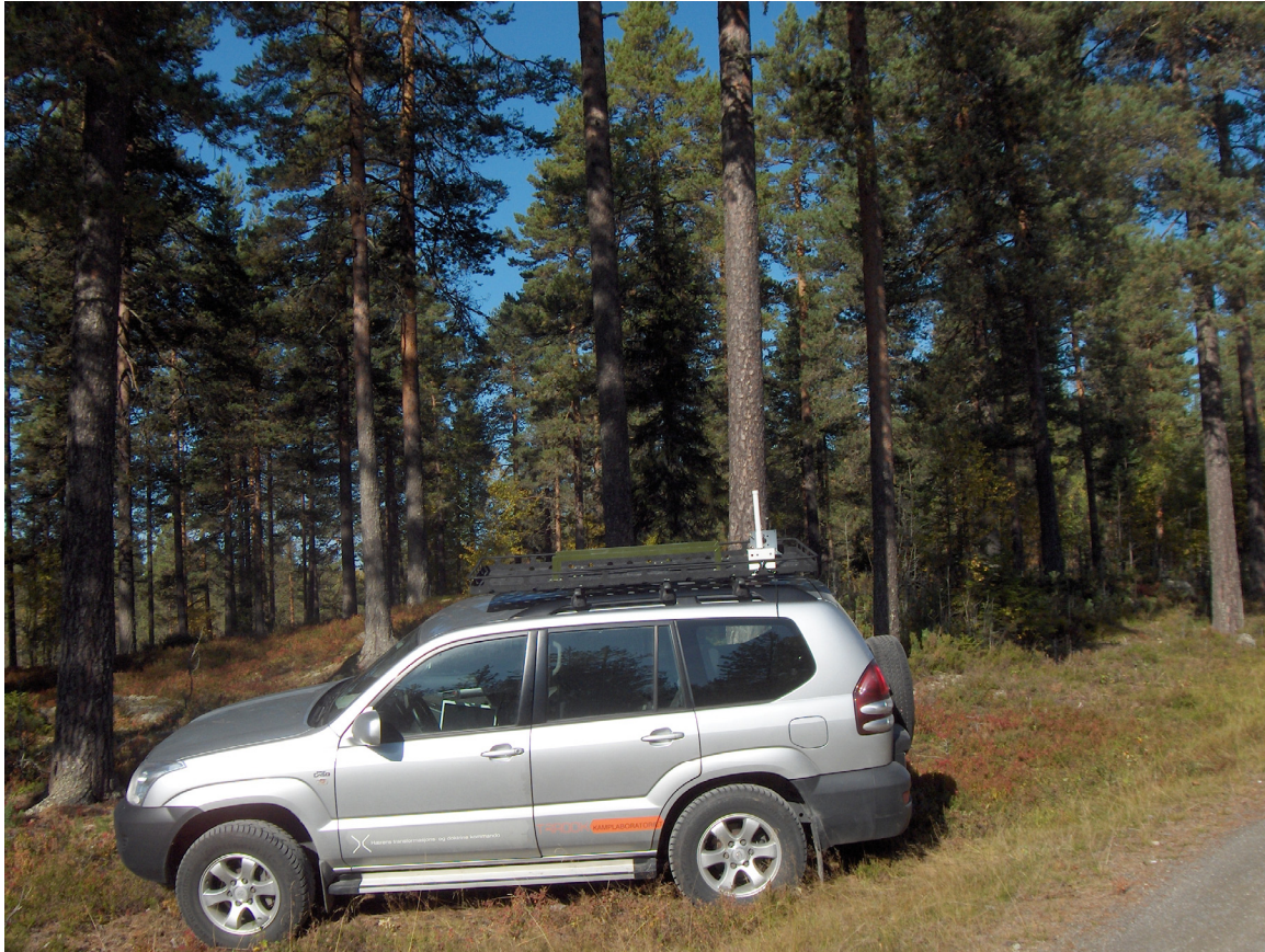
Figur 2.11 Testplattform. Kjøretøy med fastmontert CPE og antenne.
