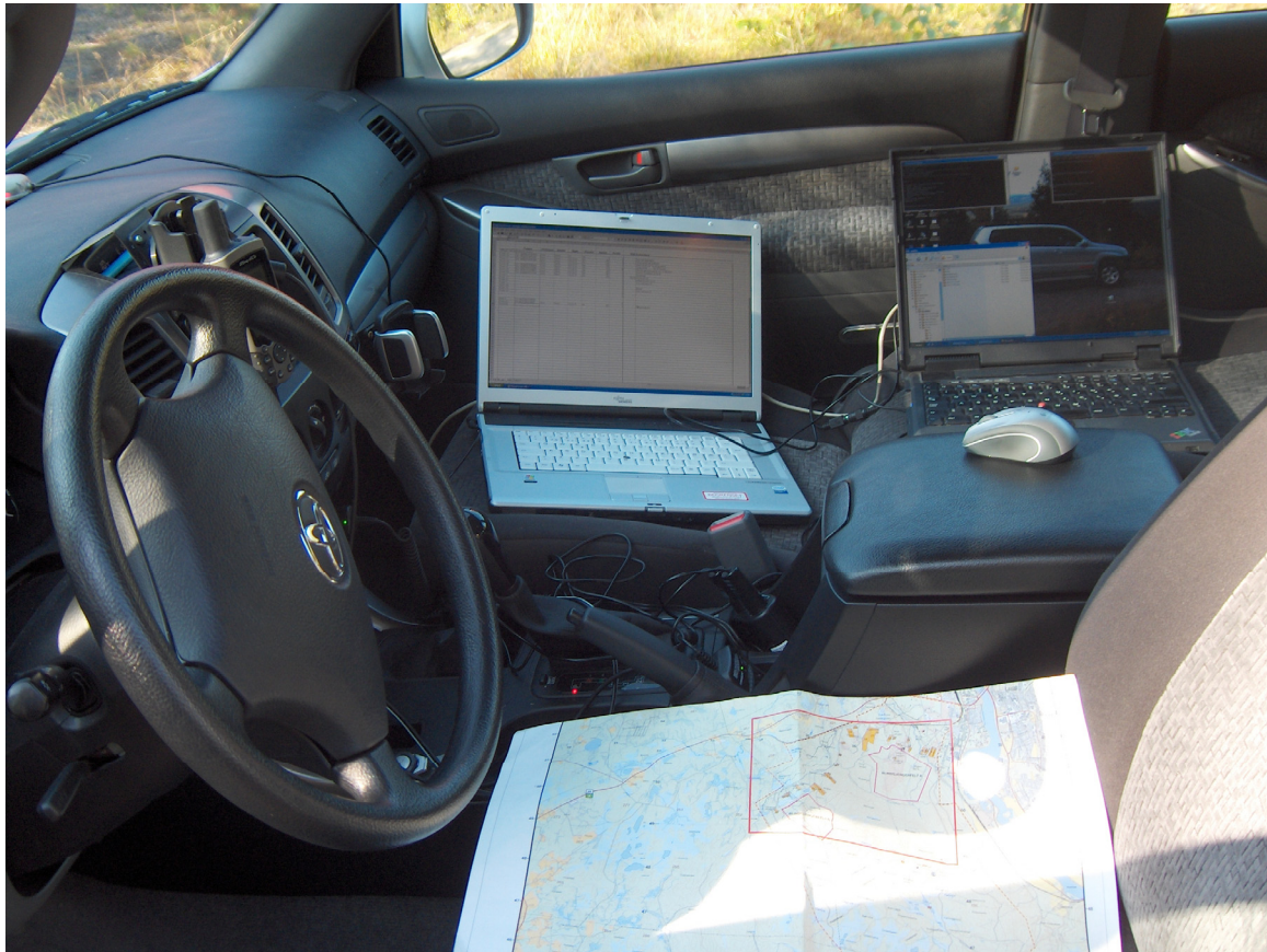
Figur 2.12 Testplattform innvendig. PC for logging av nettverksparametere, posisjon mm.
