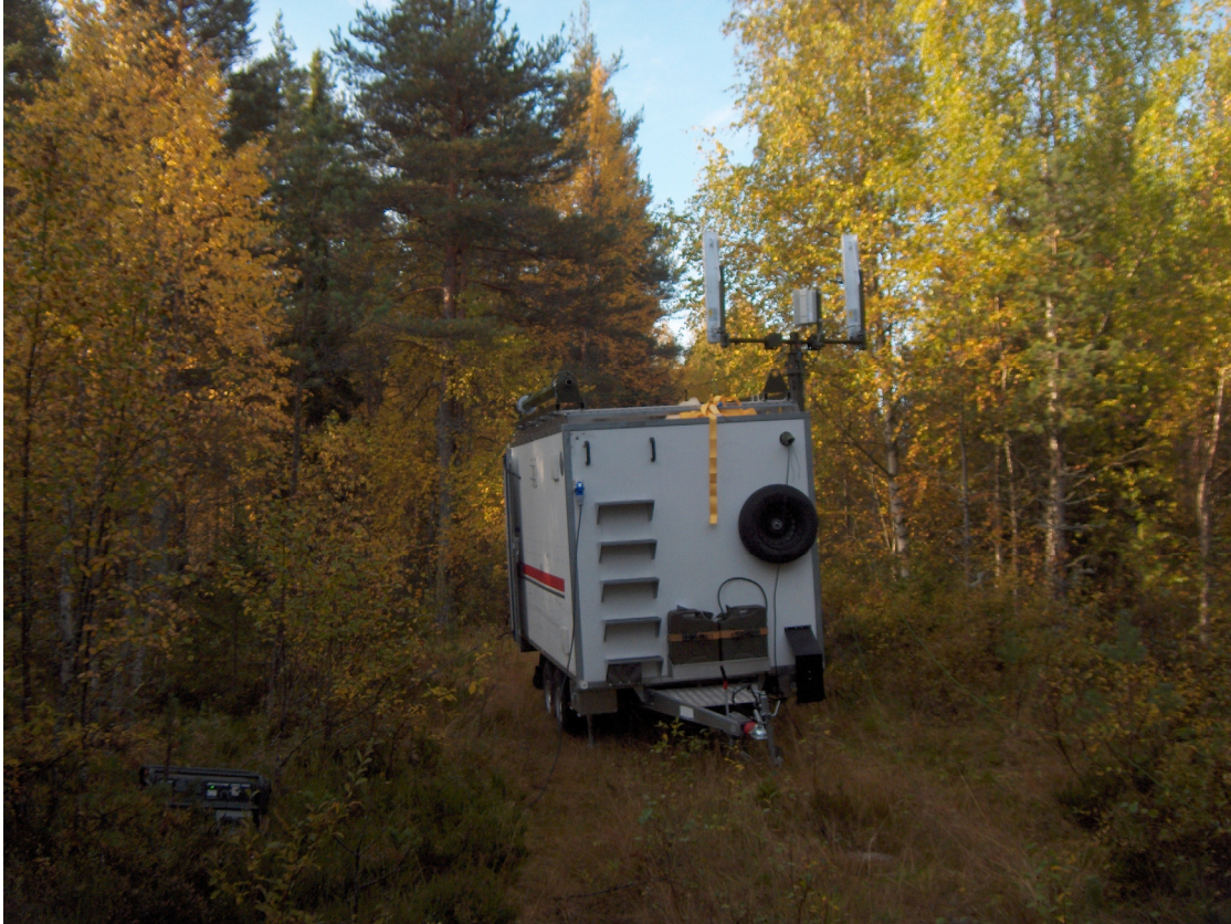
Figur 2.6 Deployert basestasjon med aggregat og antenner.
