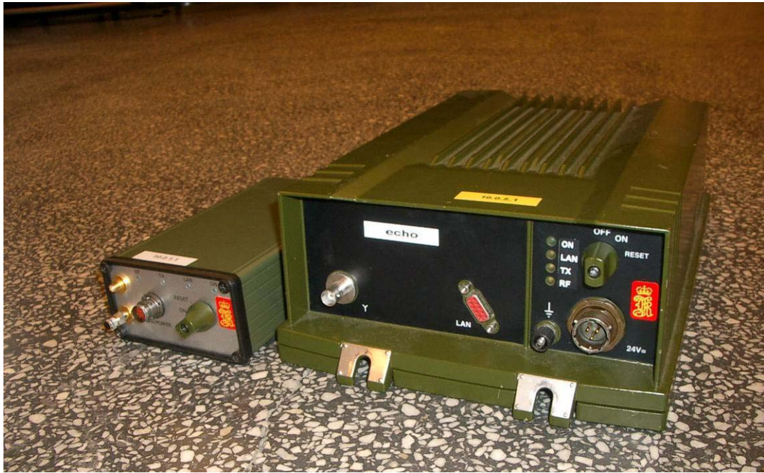
Figur 3.3 WM600, for montering i kjøretøy, til høyre, og den mindre soldatmodellen til venstre.
