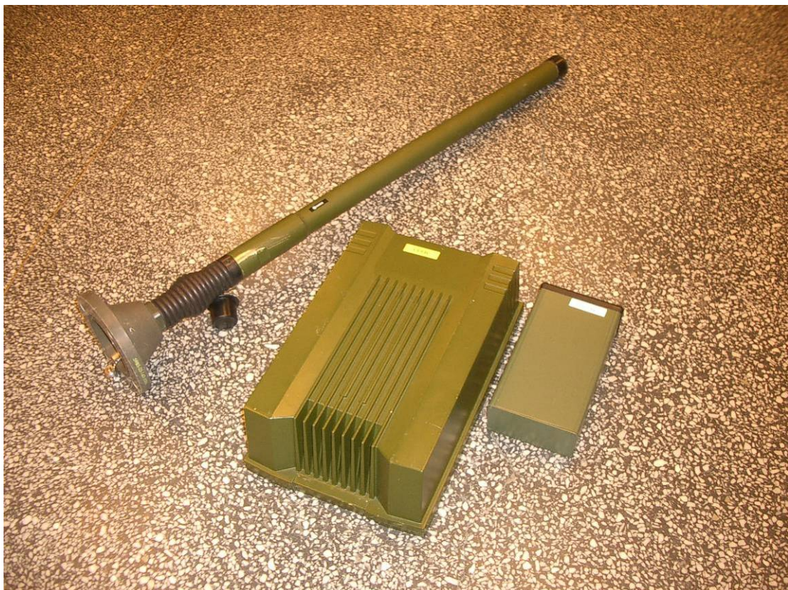
Figur 3.4 To modeller av WM600 med antenne av den typen som ble brukt i eksperimentet. Antennen med fot er 87.5 cm lang.
