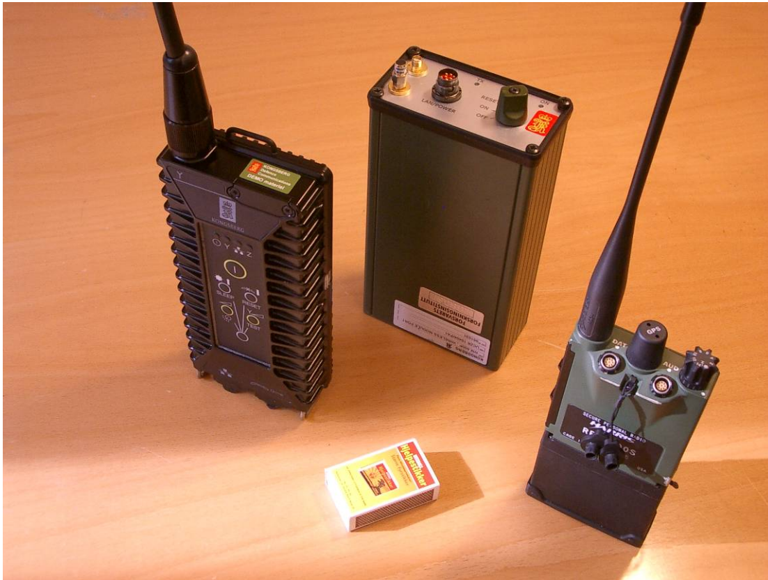
Figur 4.1 Kongsberg SR600 til venstre, Harris RF-7800S-TR til høyre og prototypen av SR600 bak i midten.
