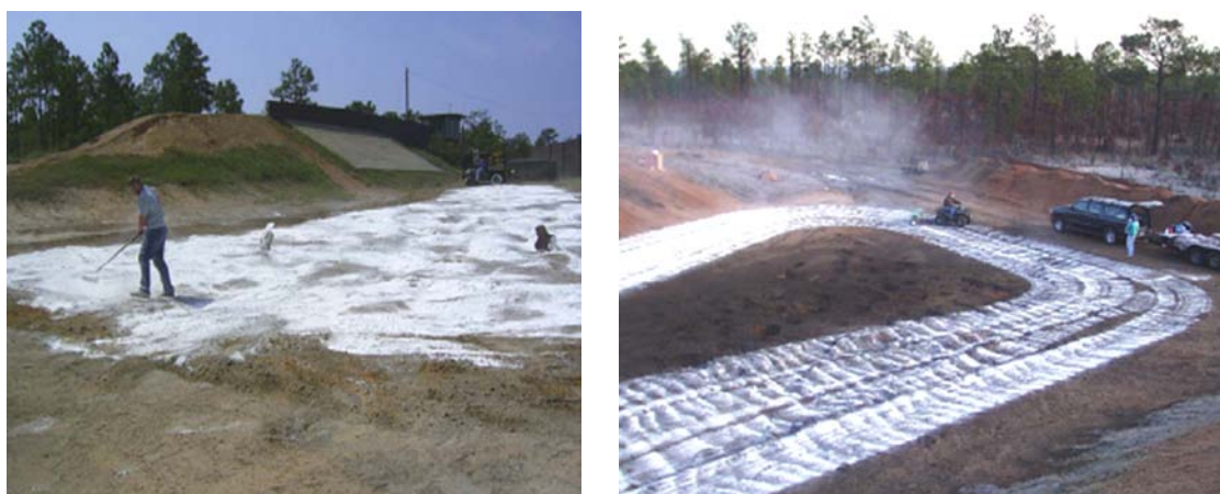
Figur 1.2 Feltstudie gjennomført av Larson et al. 2008 ved Fort Jackson, USA. En håndgranatbane forurenset med RDX ble tilsatt 3 % hydratkalk i topplaget av jorden [10].
