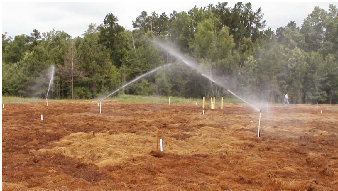
Figur 1.3 Feltforsøk ved Longhorn Army Ammunition Plant, USA [16]. Jord forurenset med eksplosiver og perklorater ble iblandet hestemøkk og dekket med høy.
