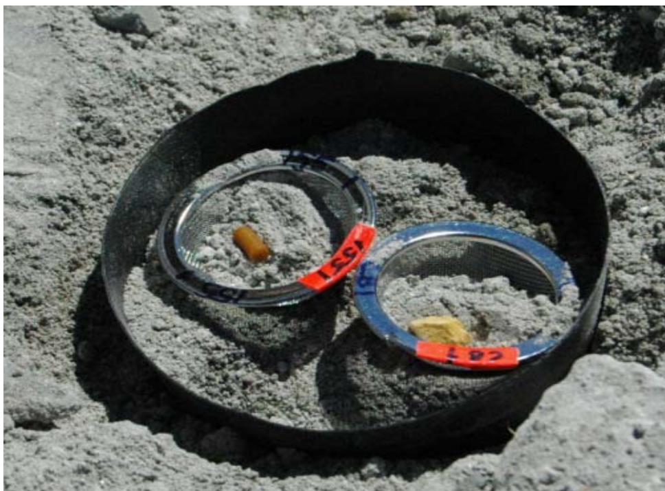
Figur 2.5 Eksplosivpartiklene ble plassert i en sil i en bøtte og gravd ned i de forskjellige områdene. Bildet viser partiklene plassert i området behandlet med hydratkalk.
