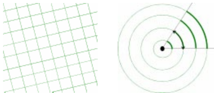
Figur 3.1 Eksempel på dekningsområder. Nett med bruddeteksjon (til venstre) har dekning over hele nettet. Dekningsområde for sonar (til høyre) er en strekning langs utbredelsen til lydbølgene, men vanligvis avgrenset til en sektor, som den markert med mørk farge i 2D-skissen
