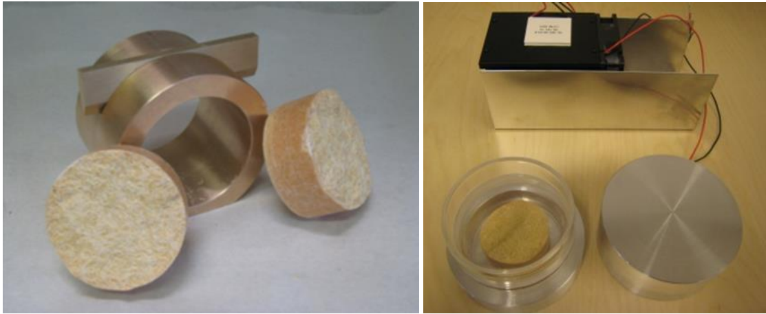
Figur 7.7 TNT-sylinder kuttet i to og gjort klar til lagringsforsøk
