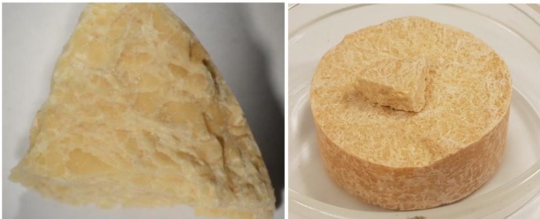
Figur 7.9 Biter av TNT før (til venstre) og etter (til høyre) lagringsforsøk
