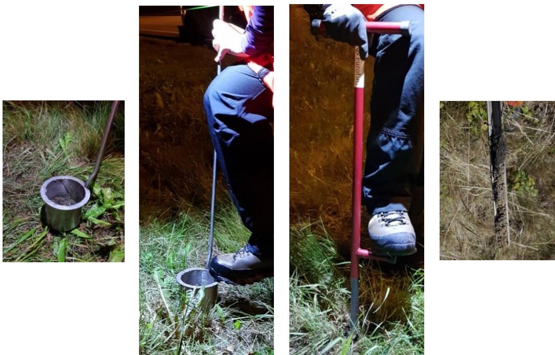
Figur 2.5 Bilder av prøvetaking av blandprøvene (til venstre) og enkeltprøvene i dybden med jordbor (til høyre) (Foto: Statens vegvesen).
