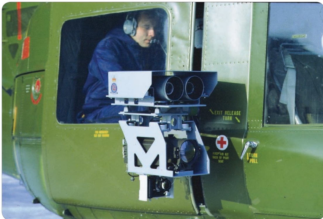
Det er blitt foretatt en mengde kamuflasjeregistreringer fra helikopter. Bildet viser Tor Høimyr som styrer en plattform med kameraer for visuelle, nærinfrarøde og termiske videoopptak.
