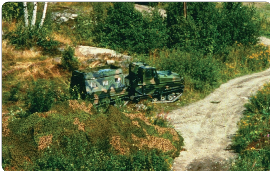
To beltevogner med tilhenger i terrenget. Den ene er kamuflasjemalt, den i forgrunnen er kamuflert med nett. Kamuflasjennettene er laget på grunnlag av spesifikasjoner fra FFI.
