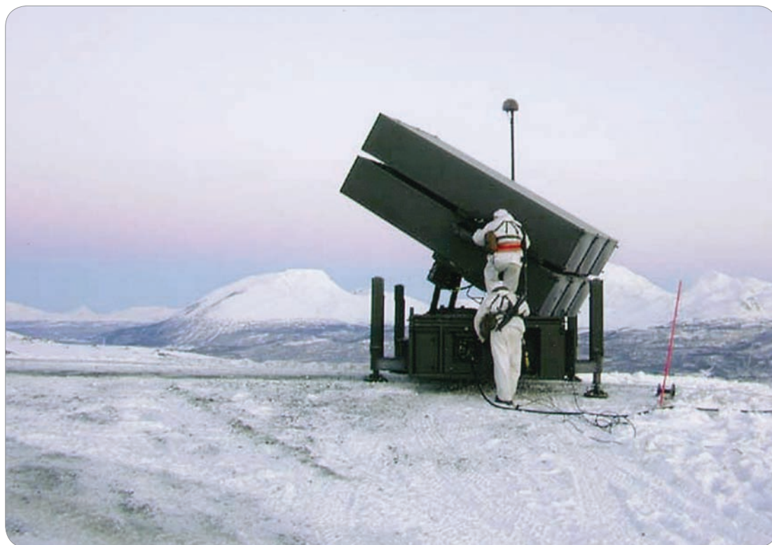
NASAMS launcher klargjøres til skudd. Launcheren er konstruert og produsert av Norsk Forsvarsteknologi (Nå Defence & Aerospace A/S), Kongsberg, basert på en ide fra Luftforsvarets forsyningskommando. Foto:Fotoavdelingen Bardufoss flystasjon 1999.
