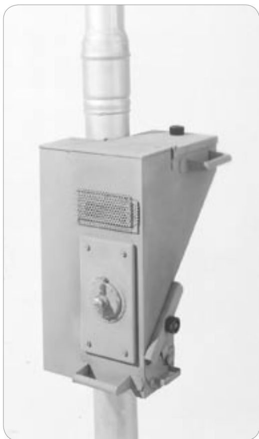
Teltovn basert på trekullfyring utviklet for Hæren i begynnelsen på 1990-tallet. Effekt 2-7 kW. Omlag 80% virkningsgrad.
