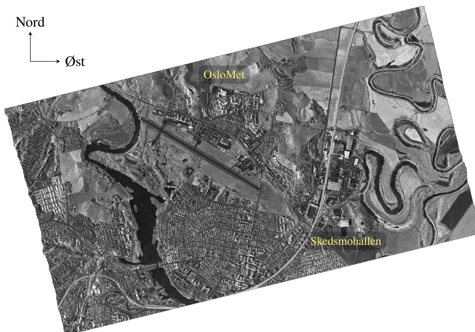
Figur 6.10 Geokodet Staring Spotlight TSX-bilde fra 10. mars 2015. Pikkelsestørrelsen er 1,8 m og innfallsvinkelen er 32°. (© SLC provided by DLR 2015. Prosessering fra SLC utført på FFI)
